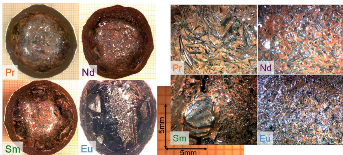
Figure III. 7. Cristaux de BLnFNO (avec Ln=Pr, Nd, Sm et Eu) localisés à la surface des solutions solidifiées en fin de croissance.
