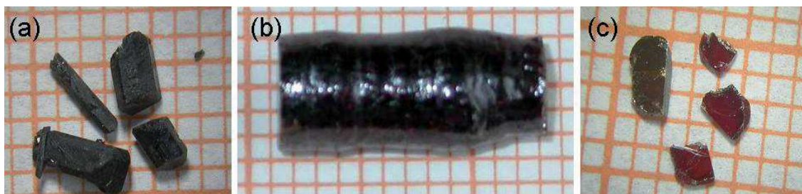
Figure IV. 5. (a) Cristaux de MnWO_4 obtenus par la méthode des flux, utilisant Na_2WO_4 en tant que solvant. (b) Massif cristallisé par fusion de zone verticale dans un four à image, puis (c) clivé perpendiculairement à l'axe b [11].
