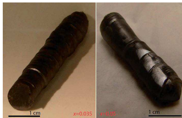
Figure IV. 6. Cristaux de Mn 1-x Fe x WO 4 (x=0,035 et x=0,05) obtenus par croissance en four à image [26].
