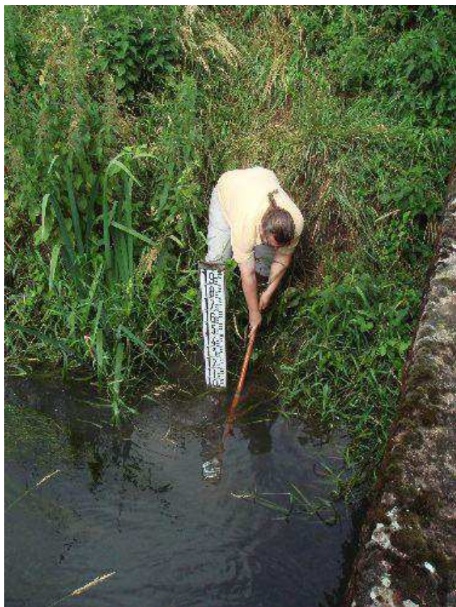
Figure 2.13. Prélèvement d'eau effectué dans le cadre du suivi qualitatif des cours d'eau par l'Agence de l'Eau Rhin-Meuse (Petite Seille à Haboudange). Crédit photo : AERM.
