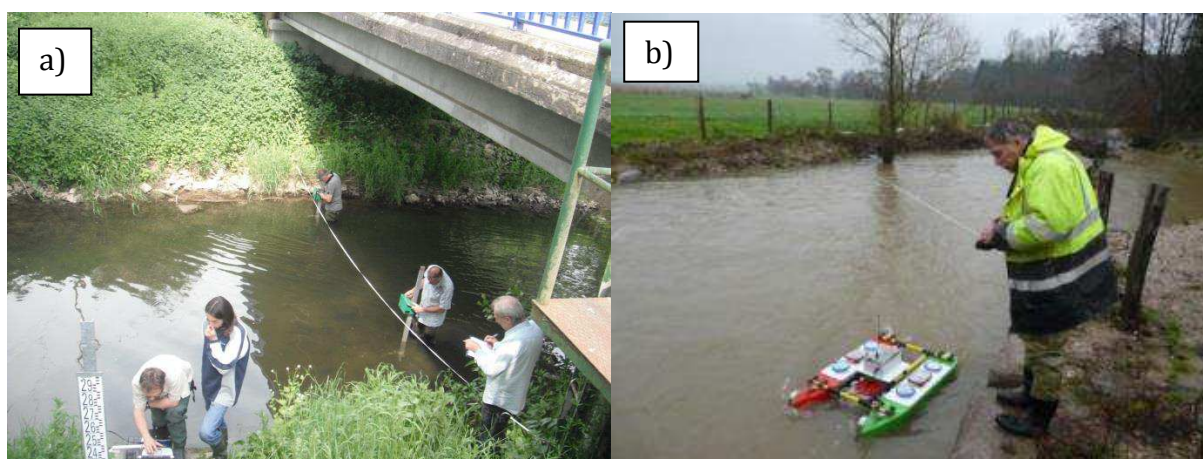
Figure 2.17. Jaugeages en rivière par technique intrusive. a) Jaugeage au moulinet effectué dans le cadre du tarage et du suivi dynamique des stations hydrométriques. b) Jaugeage « ponctuel » par ADCP. Crédits photos : DREAL Lorraine (Pôle Hydrométrie et réseaux de mesure).
