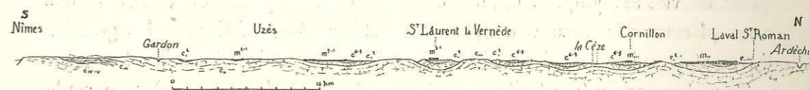
Fig. 249. — Coupe nord-sud prise sur la rive droite du Rhône, montrant l'allure des plis éocènes dans une région qui n'a pas été remaniée ultérieurement.
