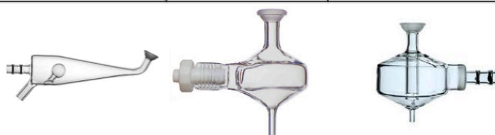
Figure 20 : Nombre moyen de coups par seconde dans une solution de HNO 3 0.1N (soit le blanc) en fonction de la chambre de nébulisation utilisée, toutes autres conditions égales. Les illustrations montrent la forme, et donc le fonctionnement, de ces différentes chambres de nébulisation (la photo de chambre à bille d'impact montrée ici est celle d'une chambre en verre borosilicaté, afin de pouvoir montrer la bille d'impact).
