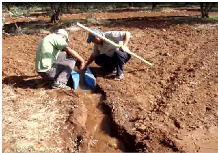
Figure 13. Mesure de débit à l'entrée de la parcelle par un seuil Parshall
