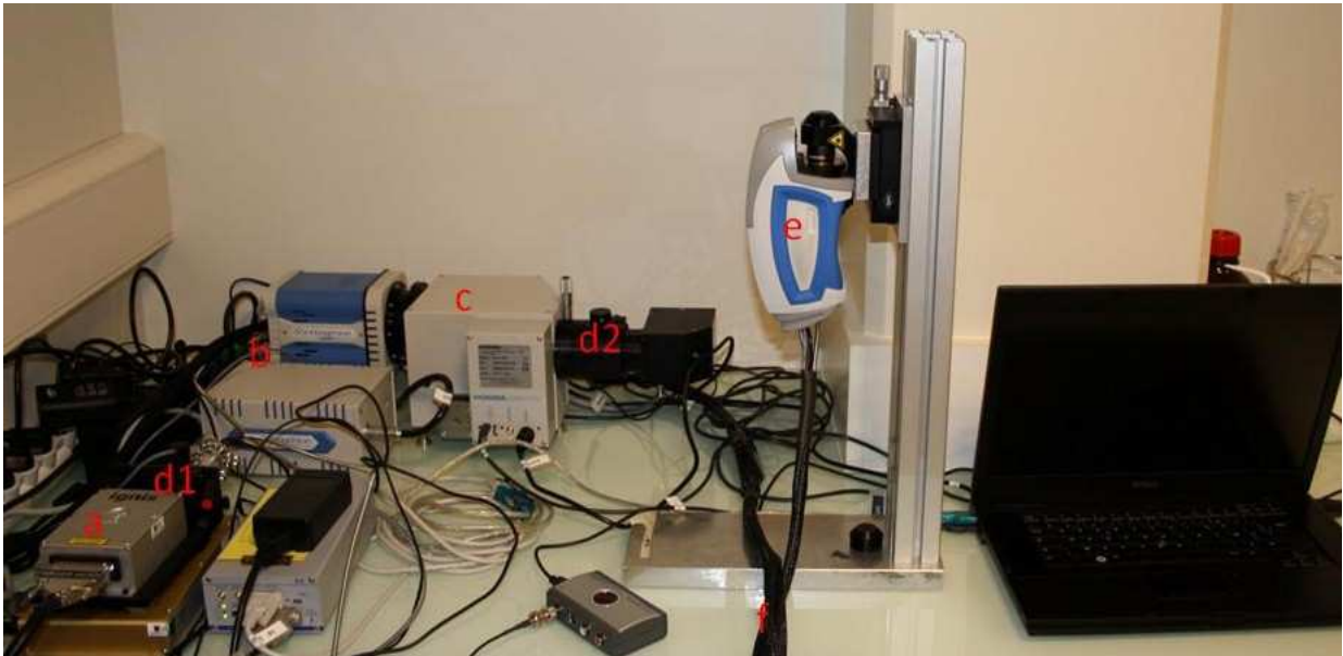
FIGURE 12: SYSTEME MICRO-SONDE RAMAN: (A) SOURCE LASER, (B) CHARGED COUPLED DEVICE (CCD), (C) MICRO HR, (D1 ET D2) SHUTTER LASER ET SHUTTER SPECTROMETRE RESPECTIVEMENT, (F) FIBRE PERMETTANT UNE CONFOCALITE DE 5 \mu M ET (E) MICRO-SONDE CONFOCALE
