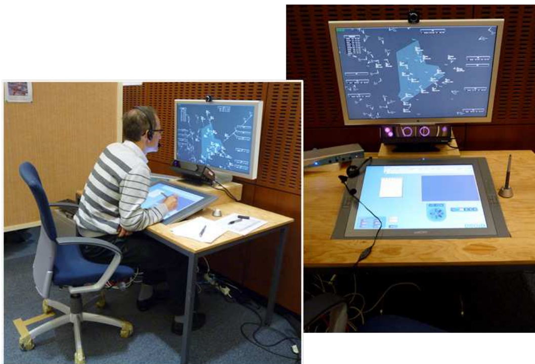
Figure 71. La position expérimentale composée d'une interface tout électronique et dans laquelle un eye-tracker a été intégré
