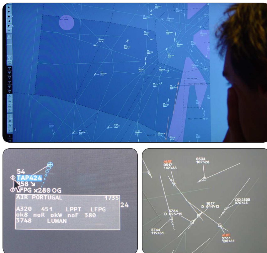
Figure 9.1. L'image radar ODS utilisée en CCR – Figure 9.2. Le plot et l'étiquette radar d'ODS – Figure 9.3. Une alarme STCA
