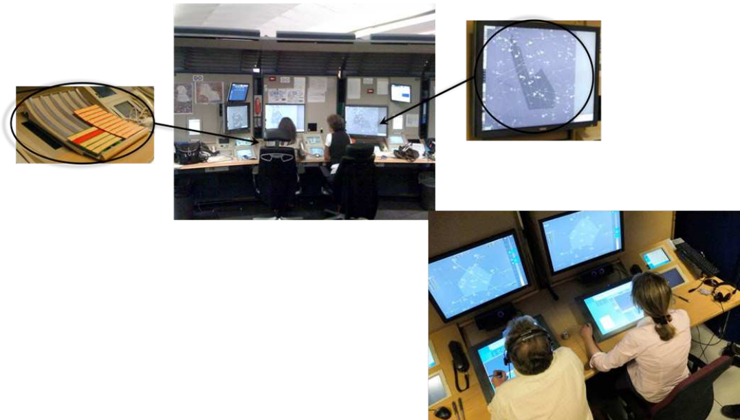
Figure 51. La position de contrôle actuellement mise en place en centre de contrôle En-Route (gauche) et la position de contrôle utilisée lors de l'expérimentation (droite)
