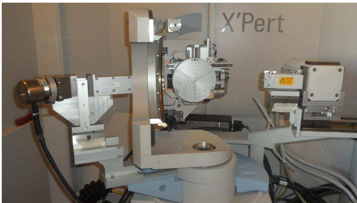
Figure 2.9. Photographie du diffractomètre X'Pert Pro, avec de droite à gauche : le tube, le système de fentes croisées, le porte échantillon et les optiques polycapillaires.
