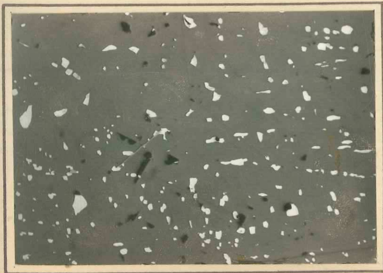
Photo N° 6. Chalcopyrite en exsolution dans de la blende.
