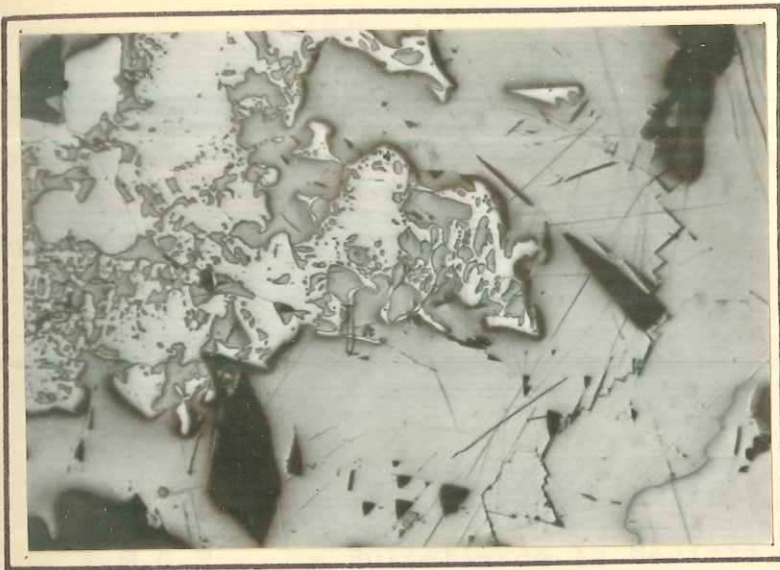
Photo N° 7. Remplacement d'un cristal de pyrite par de la galène. (Lumière naturelle. Grossissement Leitz - 5.6)
