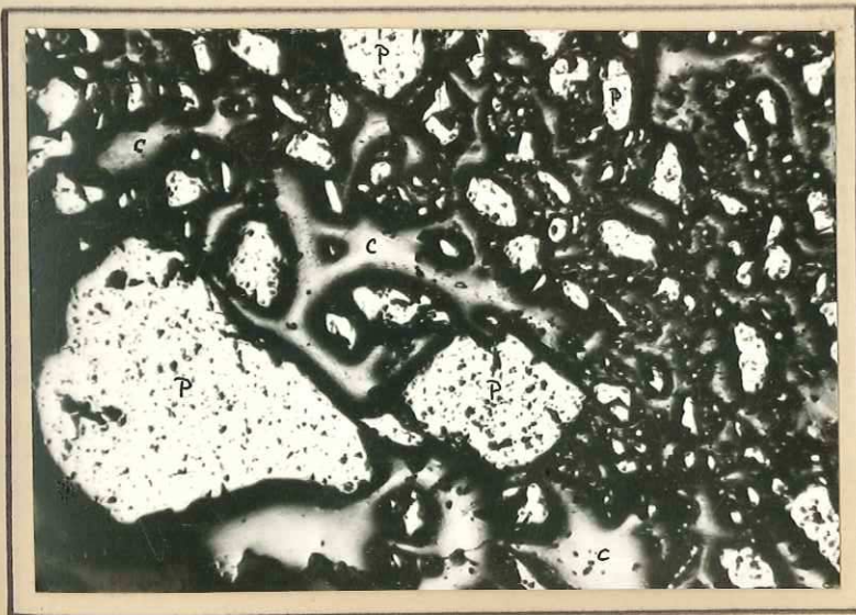
Photo N° 4. Cristaux de pyrite primaire enserrés dans un réseau de chalcopyrite.
