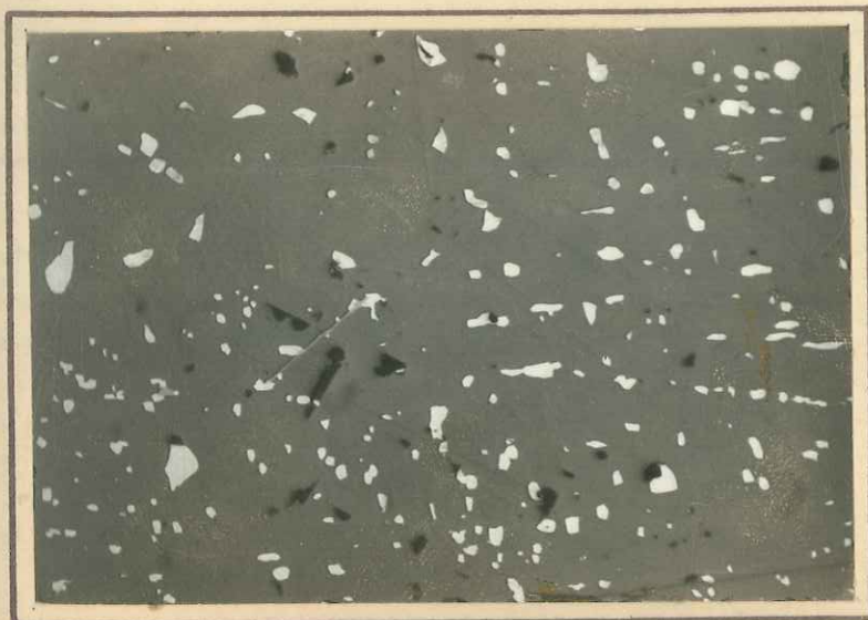
Photo N° 6. Chalcopryrite en exsolution dans de la blende. (Lumière naturelle. Grossissement Leitz - 16)
