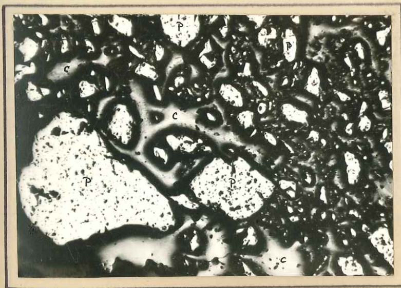
Photo N° 4. Cristaux de pyrite primaire enserrés dans un réseau de chalcopyrite. (Lumière naturelle, Grossissement Leitz - 5,6)
