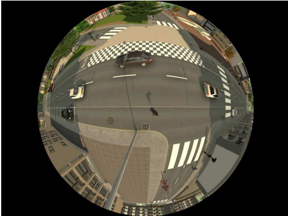
FIGURE 4.13 – Simulation d'un capteur fisheye d'ouverture 185° à 7 m du sol
