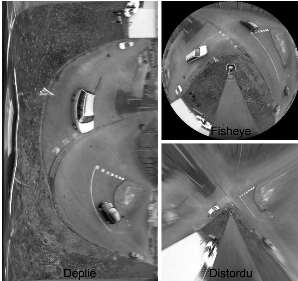
FIGURE 4.29 – Les trois modes de transformation différents pour un traitement multi-couches
