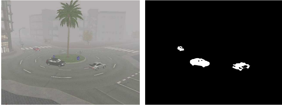
FIGURE 3.12 – Détection avec du brouillard et du bruit
