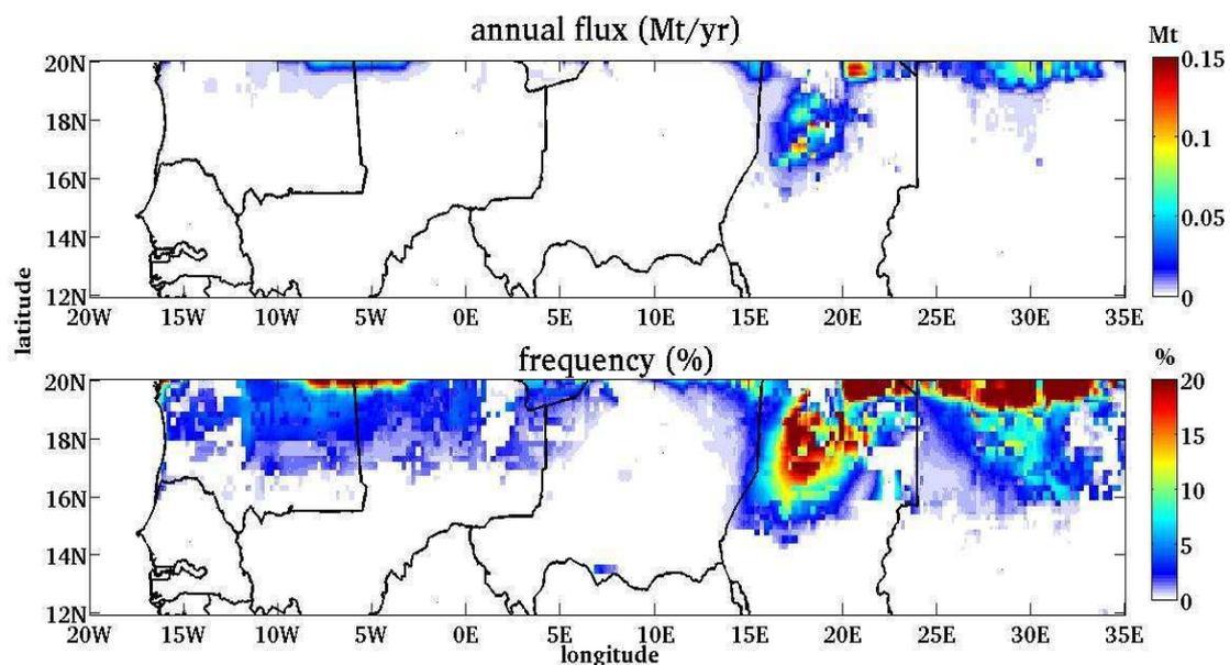
**Figure 4-26 :** Cartes des émissions annuelles d'aérosol sahélien (haut) et des fréquences d'émissions (bas) en 2004 simulées par le modèle DPM, à la résolution de  $0.10^\circ$ , pour une surface sèche et dépourvue de végétation.
