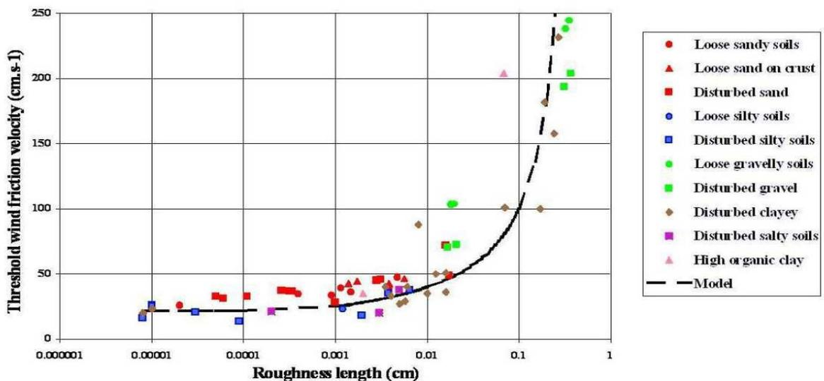
**Figure 4-6 :** Vitesse de friction seuil en fonction de la hauteur de rugosité de la surface, pour une hauteur de rugosité lisse valant  $10^{-3}$  cm, d'après la paramétrisation (6) (courbe) et des mesures de Gillette et al., 1982, et Nickling et Gillies, 1989 (points). (Marticorena and Bergametti, 1995)
