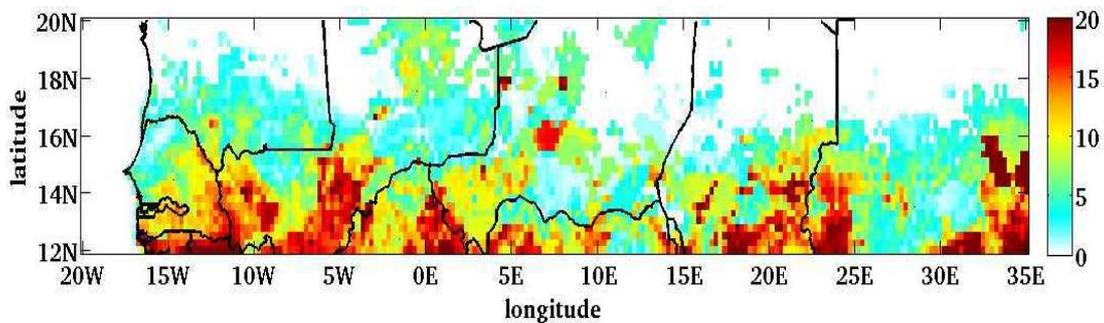
**Figure 4-10** : Humidité gravimétrique de la couche superficielle du sol au 1<sup>er</sup> septembre 2004 obtenue avec le modèle STEP forcé par le produit de pluie TRMM 3B42.
