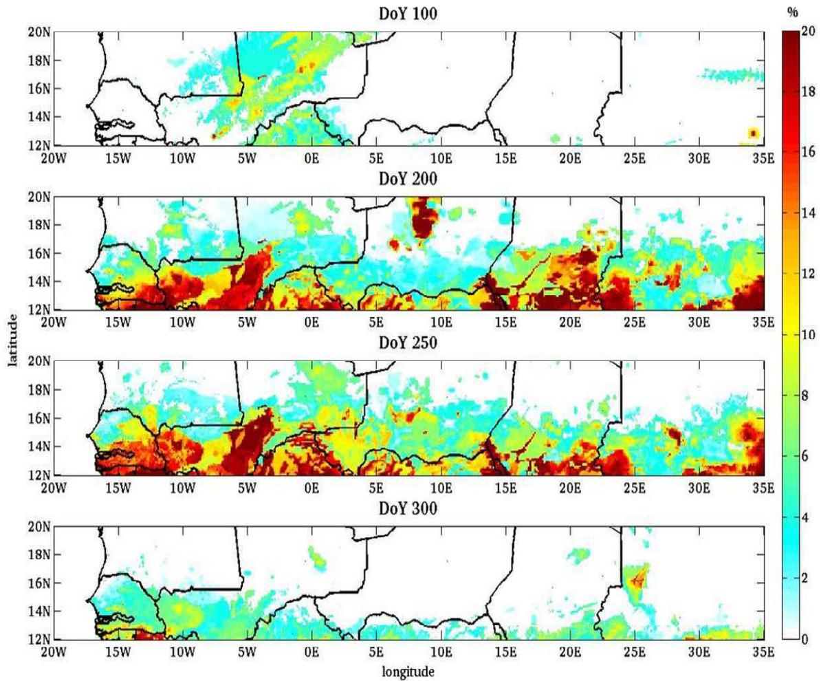
**Figure 4-13 :** Cartes de l'humidité gravimétrique de la couche superficielle du sol simulée par le modèle STEP forcé par le produit de pluie RFE2.0 pour les 100<sup>ème</sup>, 200<sup>ème</sup>, 250<sup>ème</sup> et 300<sup>ème</sup> jours de l'année 2004 (DoY : Day of Year).
