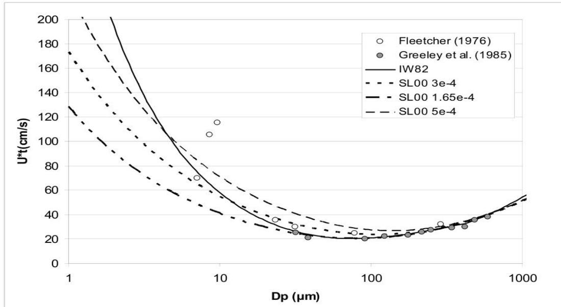
**Figure 4-5 :** Vitesses de friction seuil en fonction du diamètre des particules de sol, d'après : Iversen and White, 1982 (IW82) ; Shao and Lu, 2000 (SL00) pour différentes valeurs de  $\gamma$  ; et mesures en soufflerie de Fletcher, 1976 et Greeley et al., 1985. (Laurent, 2005)
