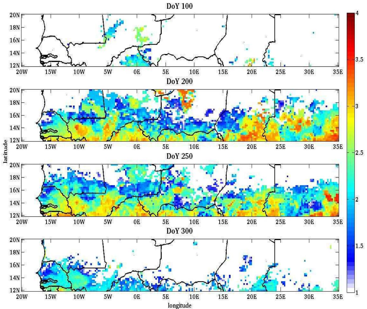
**Figure 4-17 :** Cartes du rapport de la vitesse de friction seuil minimale tenant compte de l'humidité gravimétrique de la couche superficielle du sol telle que simulée par le modèle STEP forcé par le produit de pluie TRMM3B42 sur la vitesse de friction seuil minimale pour un sol sec pour les 100<sup>ème</sup>, 200<sup>ème</sup>, 250<sup>ème</sup> et 300<sup>ème</sup> jours de l'année 2004 (DoY : Day of Year).
