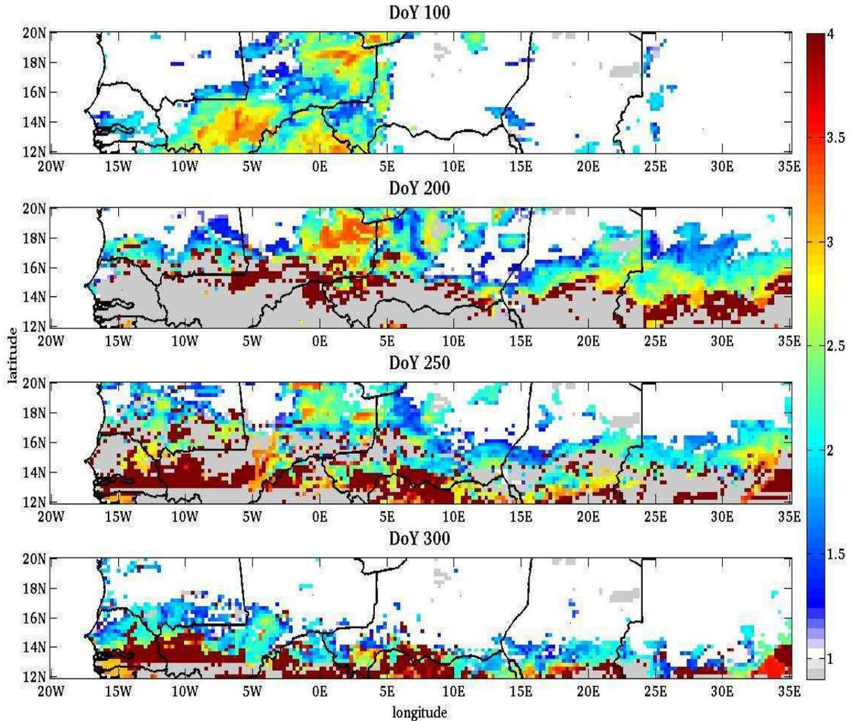
**Figure 4-21** : Cartes du rapport de la vitesse de friction seuil minimale tenant compte de l'humidité gravimétrique de la couche superficielle du sol et de la présence de végétation telles que simulées par le modèle STEP forcé par le produit de pluie CMORPH sur la vitesse de friction seuil minimale pour un sol sec pour les 100<sup>ème</sup>, 200<sup>ème</sup>, 250<sup>ème</sup> et 300<sup>ème</sup> jours de l'année 2004 (DoY : Day of Year).
