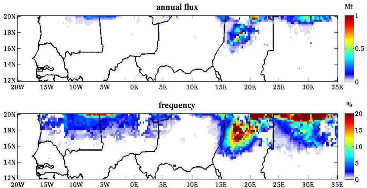
**Figure 4-29 :** Cartes des émissions annuelles d'aérosol sahélien (haut) et des fréquences d'émissions (bas) en 2004 simulées par le modèle DPM, forcé par l'humidité superficielle et la rugosité calculée à partir de la végétation simulée avec le produit de pluie TRMM3B42.
