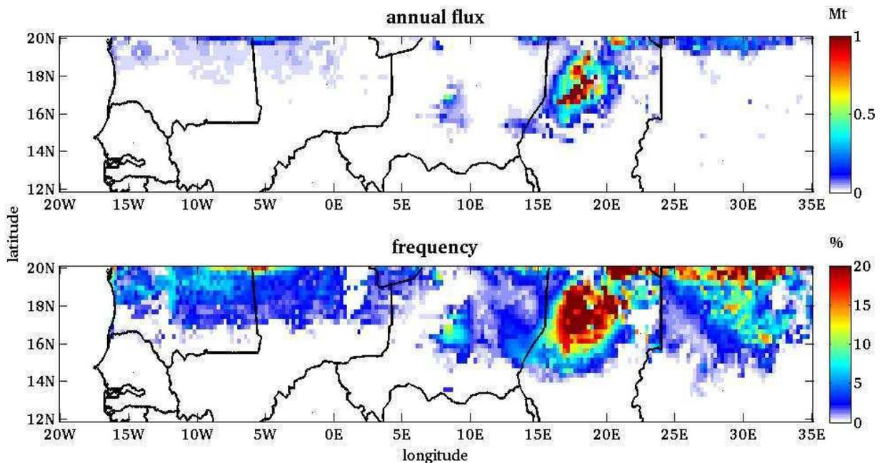
**Figure 4-32 :** Cartes des émissions annuelles d'aérosol sahélien (haut) et des fréquences d'émissions (bas) en 2006 simulées par le modèle DPM, forcé par la rugosité calculée à partir de la végétation simulée avec le produit de pluie TRMM3B42.
