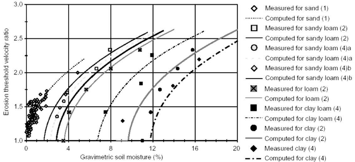
**Figure 4-7 :** Rapports des vitesses de friction seuil « humide » sur « sèche » mesurées et calculées en fonction de l'humidité gravimétrique du sol (mesures : (1) Belly, 1964 ; (2) Bisal and Hsieh, 1966 ; (4) Saleh and Fryrear, 1995 ; (4a et b) McKenna-Neuman and Nickling, 1989) (Fécan et al., 1999).
