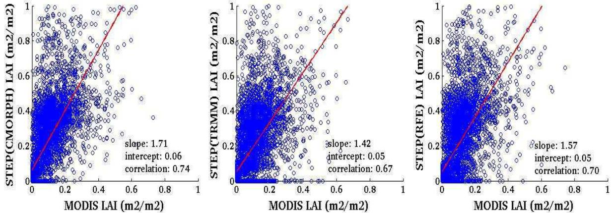
**Figure 3-38** : Graphes de dispersion et paramètres de régression linéaire (pente, ordonnée à l'origine, coefficient de corrélation) des valeurs des LAI 15 jours après le démarrage de la végétation, simulés par le modèle STEP forcé par le produit de pluie CMORPH (gauche), TRMM (milieu) et RFE (droite) en fonction des valeurs maximum des LAI MODIS, agrégés à 0.5°, pour l'année 2004 (n~6500).
