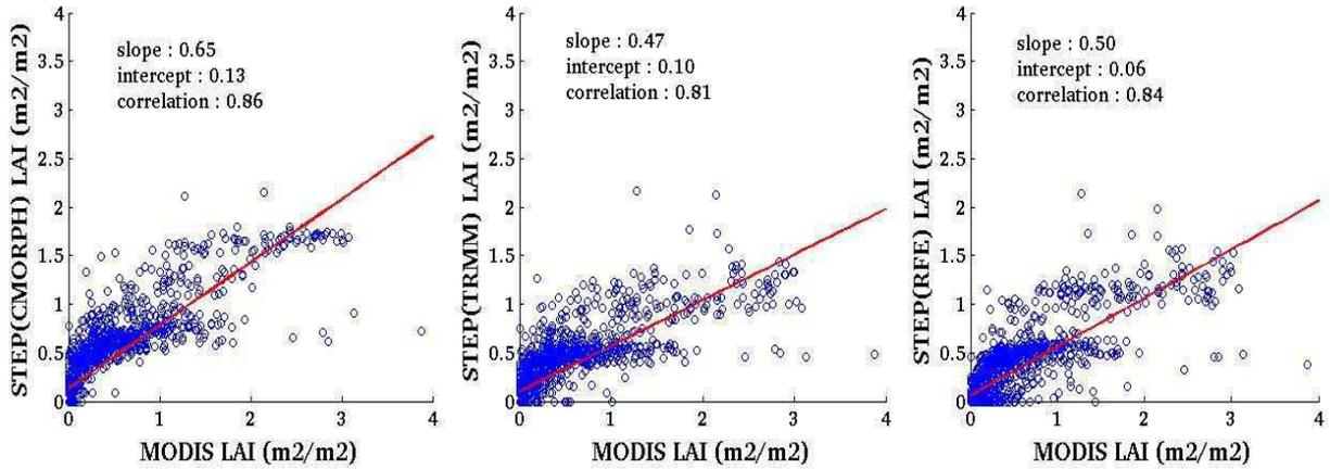
**Figure 3-28** : Graphes de dispersion et paramètres de régression linéaire (pente, ordonnée à l'origine, coefficient de corrélation) des valeurs maximum des LAI simulés par le modèle STEP forcé par le produit de pluie CMORPH (gauche), TRMM (milieu) et RFE (droite) en fonction des valeurs maximum des LAI MODIS, agrégés à  $0.5^\circ$ , pour l'année 2004 ( $n \sim 1600$ ).
