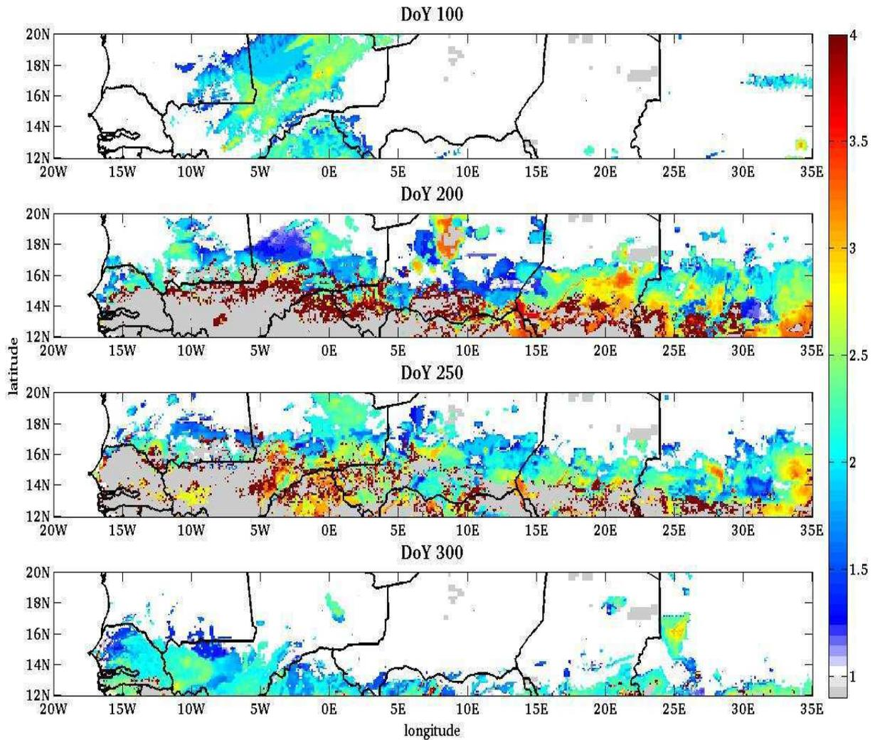
**Figure 4-22 :** Cartes du rapport de la vitesse de friction seuil minimale tenant compte de l'humidité gravimétrique de la couche superficielle du sol et de la présence de végétation telles que simulées par le modèle STEP forcé par le produit de pluie RFE2.0 pour les 100<sup>ème</sup>, 200<sup>ème</sup>, 250<sup>ème</sup> et 300<sup>ème</sup> jours de l'année 2004 (DoY : Day of Year).
