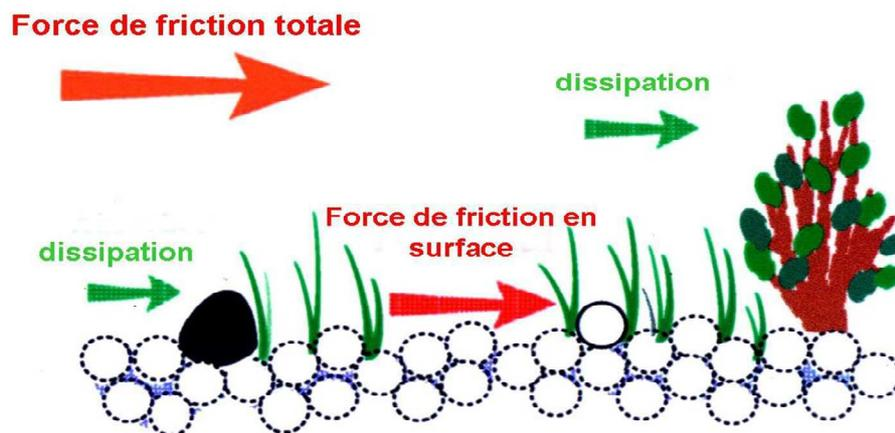
**Figure 4-2 :** Répartition de l'énergie provenant de l'action du vent sur la surface, entre surface lisse et éléments de rugosité (d'après Marticorena, comm. pers.)
