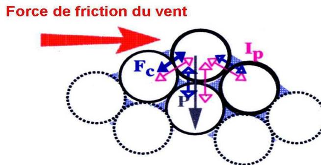
**Figure 4-1** : Forces en jeu dans la mise en mouvement des grains du sol : force de friction du vent ; poids des particules  $P$  ; forces de cohésion interparticulaires  $I_p$  et forces capillaires  $F_c$  (d'après Marticorena, comm.pers.).
