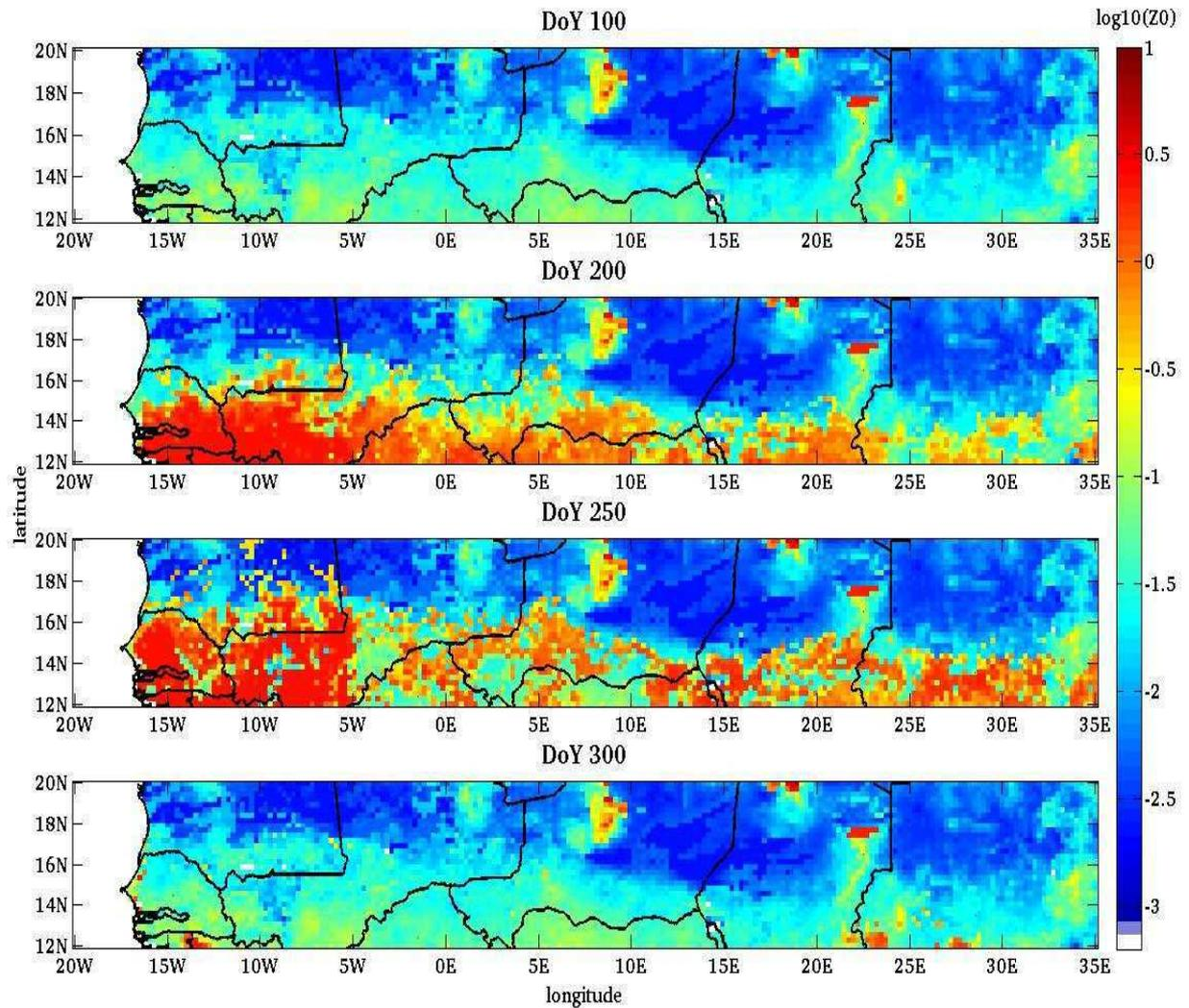
**Figure 4-20 :** Cartes des logarithmes des hauteurs de rugosité dynamique tenant compte de la rugosité statique de la surface et de la végétation simulée par le modèle STEP forcé par le produit de pluie TRMM3B42 pour les 100<sup>ème</sup>, 200<sup>ème</sup>, 250<sup>ème</sup> et 300<sup>ème</sup> jours de l'année 2004 (DoY : Day of Year).
