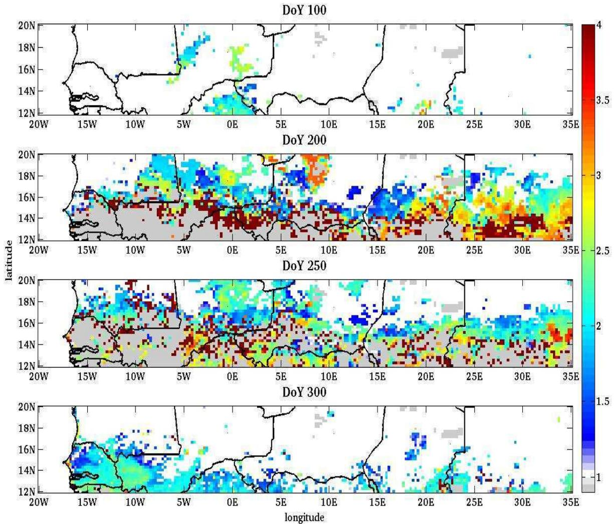
**Figure 4-23 :** Cartes du rapport de la vitesse de friction seuil minimale tenant compte de l'humidité gravimétrique de la couche superficielle du sol et de la présence de végétation telles que simulées par le modèle STEP forcé par le produit de pluie TRMM3B42 pour les 100<sup>ème</sup>, 200<sup>ème</sup>, 250<sup>ème</sup> et 300<sup>ème</sup> jours de l'année 2004 (DoY : Day of Year).
