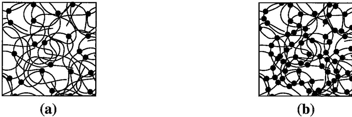
Figure 1.3: (a) Elastomère, constitué d'un réseau réticulé assez lâche; la liberté des molécules sur de grandes longueurs confère au matériau son élasticité. (b) Polymère thermostable: réseau très serré; le matériau est rigide.
