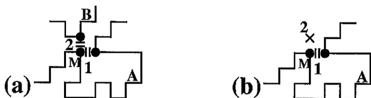
Figure 3.19: (a) Absence de volume exclu dans un fondu. Un monomère  $M$  de la chaîne  $A$  subit une interaction semblable de la part d'autres monomères de la même chaîne (1) et de la part de monomères d'autres chaînes (2). (b) Volume exclu pour une chaîne isolée. Le monomère  $M$  ne subit plus d'interaction de volume exclu de la part des molécules de solvant (2), mais seulement de la part de monomères de la même chaîne  $A$ .
