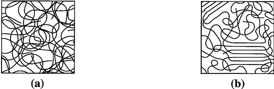
Figure 1.2: Polymère thermoplastique à l'état solide. (a) Thermoplastique amorphe: la conformation des molécules est désordonnée. (b) Thermoplastique semi-cristallin: certaines zones (domaines cristallins) présentent un arrangement ordonné de brins appartenant à des molécules différentes.
