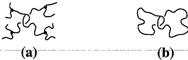
Figure 7.1: Enchevêtrements distants: la topologie est fixée. Analogie entre deux situations. (a) Dans un gel, les brins 1 et 2 ne peuvent se traverser et leurs extrémités sont fixées à d'autres chaînes (points de réticulation). (b) Dans le cas de deux polymères en anneau, les brins 1 et 2 ne peuvent se traverser et ils sont connectés sur eux-mêmes (anneaux).
