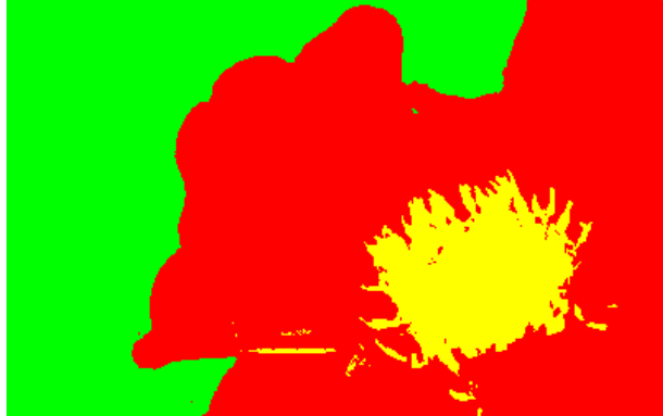
figure I.14 : Image résultant de la classification de la figure I.2 par minimisation de distance de Mahalanobis
