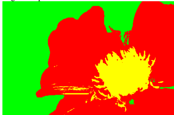
figure I.12 : Image résultant de la classification de la figure I.2 par minimisation de distance de Tchebychev
