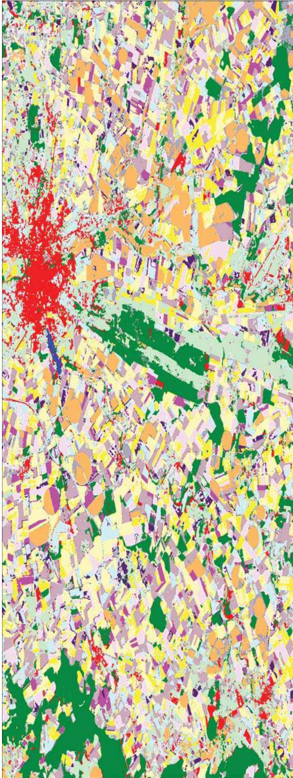
figure IV.28 : Fusion par minimisation de confusion des classifications Spot et Radarsat
