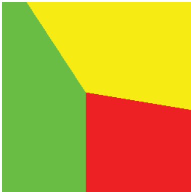
figure I.9 : Surface de décision de la méthode par minimisation de distance euclidienne
