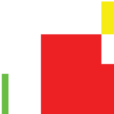
figure I.5 : Surface de décision de la méthode de classification par seuillage : parallélépipède. La superposition du rectangle rouge et du jaune rend la décision impossible.
