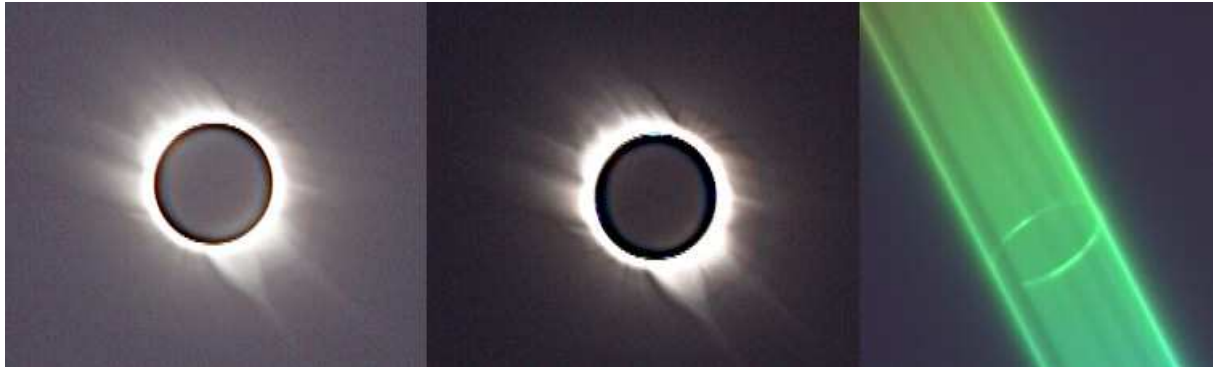
Figure III-1-3: Extrait de séquences où le réseau a été placé dans l'ordre zéro du spectre pour obtenir quelques images en lumière blanche. Le réseau a été ensuite placé à nouveau à l'ordre 1 sur la raie verte afin de comparer à basse résolution, la structuration de la raie verte et du continu coronal, par comparaison avec la couronne blanche. La dispersion est de 1.3\text{\AA}/\text{pixel} . Les images sont dans la même orientation. Les modulations dans le continu du spectre correspondent aux structures. Les images à l'ordre zéro ont subi un traitement de conversion des intensités en échelles logarithmique puis un masque flou d'une finesse de 5 pixels.
