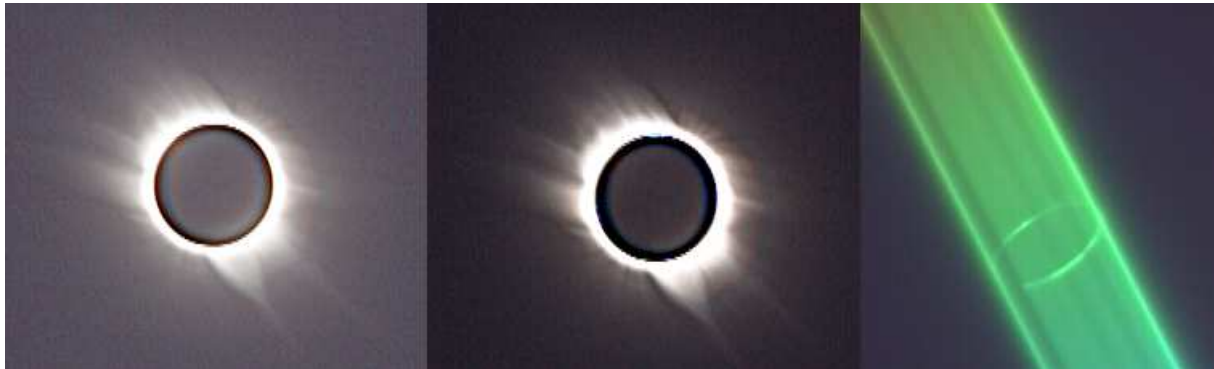
Figure III-1-3: Extrait de séquences où le réseau a été placé dans l'ordre zéro du spectre pour obtenir quelques images en lumière blanche. Le réseau a été ensuite placé à nouveau à l'ordre 1 sur la raie verte afin de comparer à basse résolution, la structuration de la raie verte et du continu coronal, par comparaison avec la couronne blanche. La dispersion est de 1.3Å/pixel. Les images sont dans la même orientation. Les modulations dans le continu du spectre correspondent aux structures. Les images à l'ordre zéro ont subi un traitement de conversion des intensités en échelles logarithmique puis un masque flou d'une finesse de 5 pixels.
