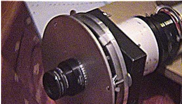
Figure II-1-1: vue des filtres amovibles de 25 mm de diamètre, comprenant une densité neutre de densité 2 suivie d'un filtre de 4700\text{\AA} et 120\text{\AA} de bande passante, placé devant le réseau qui peut tourner autour de l'axe optique de la Lunette.
