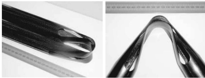
Figure I.35: Mât déployable plus ou moins plié [126]
