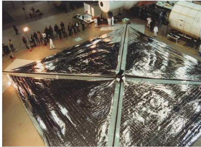
Figure I.36: Démonstration du déploiement d'une voile solaire [128]
