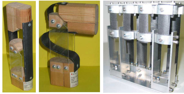
Figure I.34: Charnière développée par Boesch [29]
