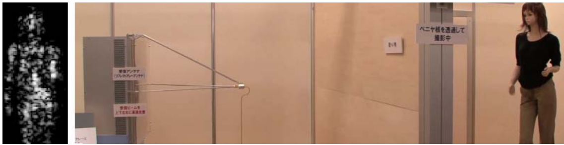
Figure I.3.2: Exemple d'une capture d'image d'un mannequin derrière un mur contreplaqué par le système d'imagerie Radar à 60 GHz développé par NHK© [17]
