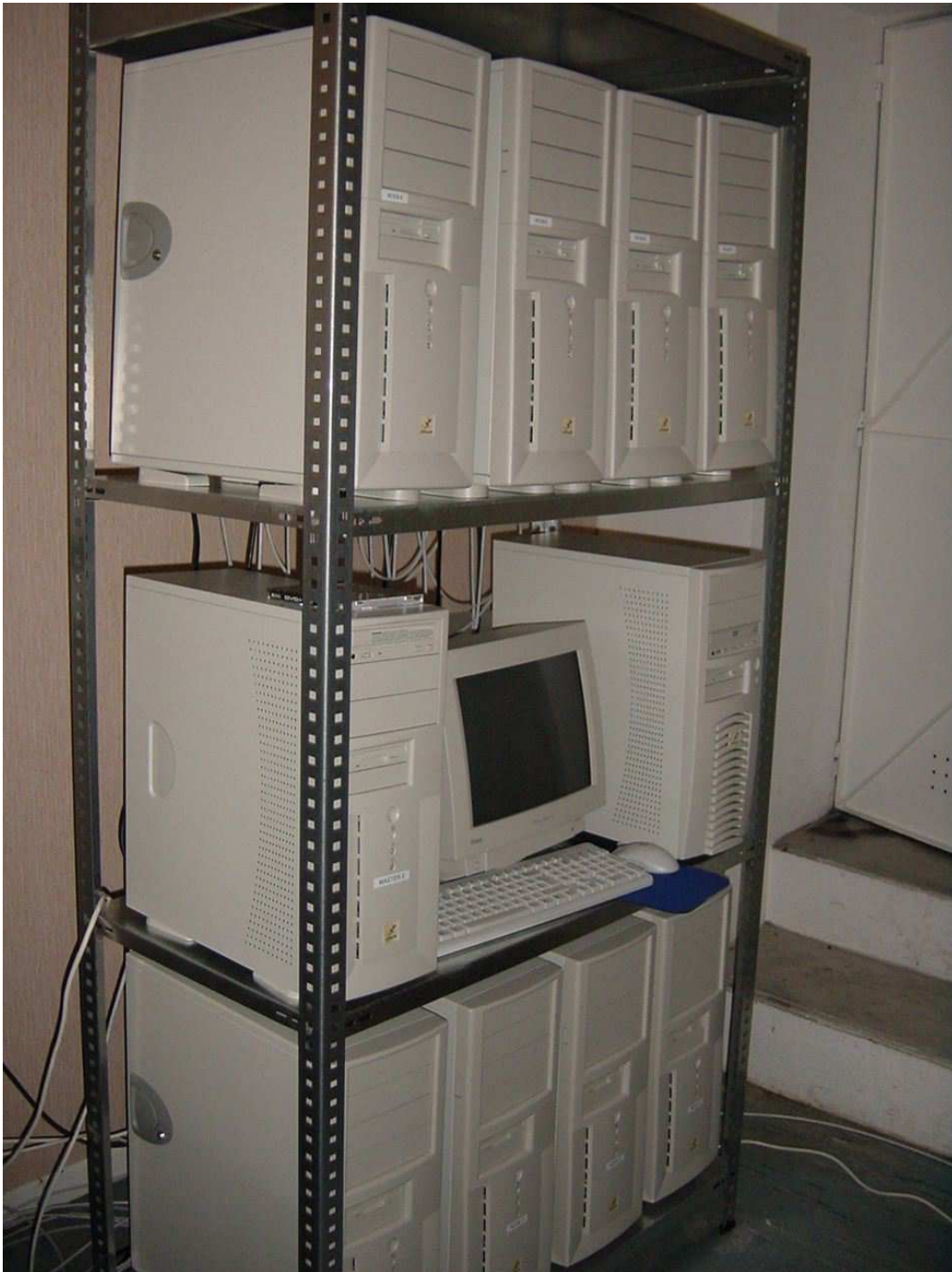
FIGURE A.11 – Cluster MADNESS ( M achine A ctively D evoted to N umerical E xperiments and S ophisticated S imulations) comportant 8 PC bi-processeurs AMD Athlon (1.8 GHz/proc) reliés par un réseau Gbytes, achetés en 2002. Ce cluster nous a permis de plonger dans l'univers du calcul parallèle.
