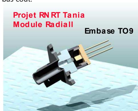
**Figure 16 :** vue éclatée du module TO conçu et réalisé par Radiall.
