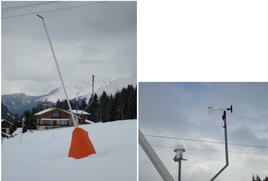
Figure. 30 Station de mesure des paramètres climatiques sur un canon bifluide aux Gets, hiver 2007. (Clichés : Janvier 2007, E. Magnier).
