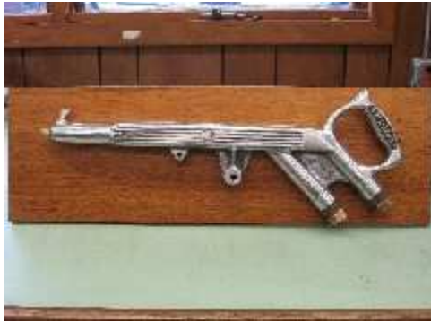
Figure. 44 Premier canon à neige, il pulvérise des cristaux de neige à une distance de plus de 18 m. ( http://www.ryereflections.org ).
