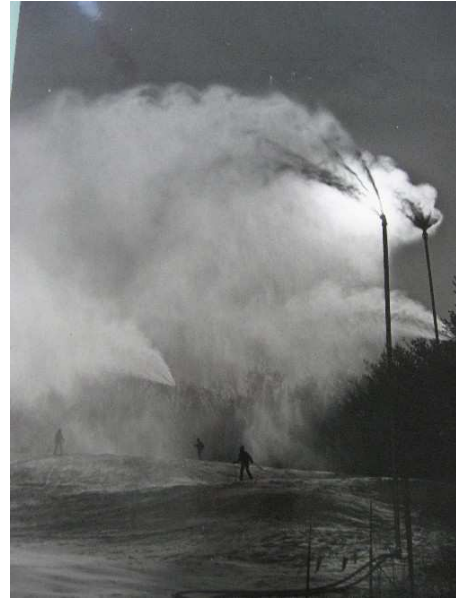
Figure. 45 Les premiers « canons tour » sur la colline de Boston Hill. ( http://www.ryereflections.org ).
