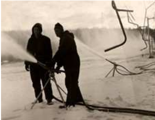
Figure. 41 Les frères Tropéano et leur canon à neige à partir du système d'irrigation portable (1950). ( http://www.jfbb.com/explore ).
