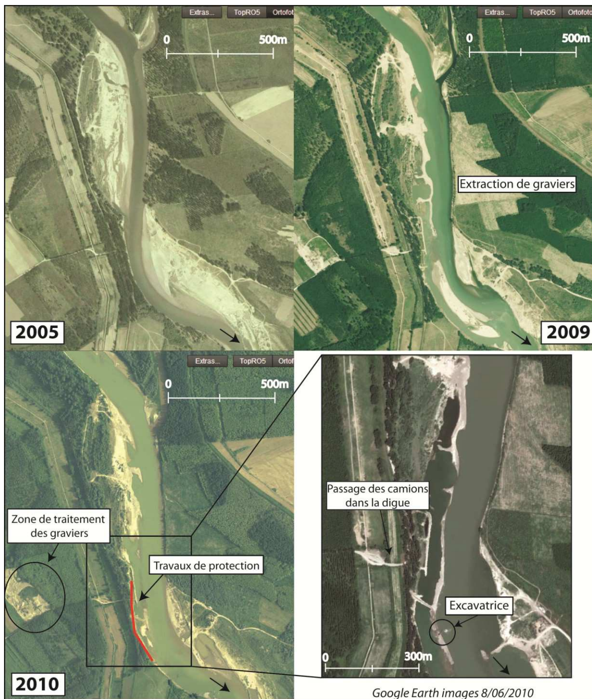
Figure 4 - 16: Evolution des berges en rive droite du Siret en amont de Vadu Roșca de 2005 à 2010 et localisation des travaux de protection des berges envisagés en 2013 (Orthophotoplans de 2005, 2009 et 2010 et Google Earth image du 6 juin 2010)
