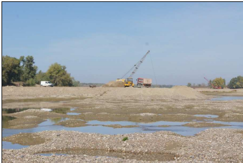
Figure 3- 55: Extraction de graviers en lit mineur par une grue excavatrice en octobre 2011 dans le Siret à hauteur du village de Biliști (Photographie: F. Salit) (Localisation Figure 3- 48)
