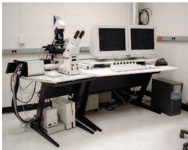
Figure 7. Confocal laser scanning microscope Leica SPE II (PIQ- Laboratoire de Biophotonique et Pharmacologie)
