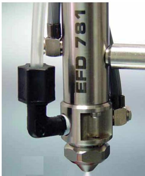
Figure 15: Buse de pulvérisation et son réservoir (EFD Inc.)
