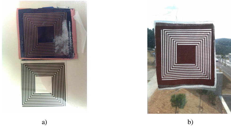
Figure II-21 – Photographies d'un échantillon d'électrotextile Taffetas Copper gravé avec l'utilisation de film photo-résistant Dupont TM Riston ® : (a) avant gravure, (b) après gravure.
