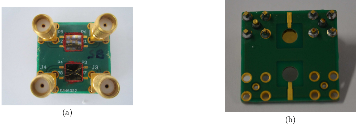
FIGURE 4.22 – Photo représentant l'étape de conditionnement des résonateurs avec les connexions électriques par soudure thermo-mécanique (a) et l'accès à la face arrière des résonateurs (b).
