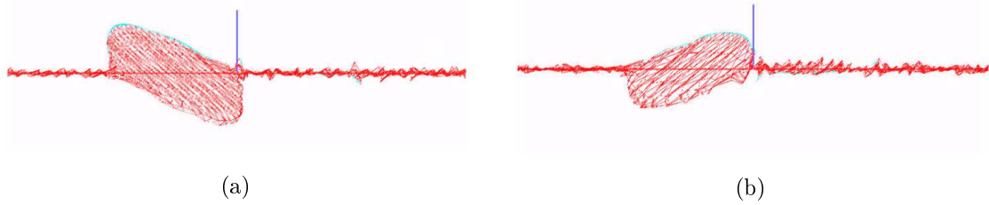
FIGURE 2.34 – Représentation du déplacement à la surface du substrat pour les ondes élastiques générées pour deux fréquences, 1,3892 (a) et 1,4114 GHz (b). La polarisation orthogonale des deux modes est ainsi visualisée, laissant présager d’une sensibilité différente aux conditions environnementales du capteur.
