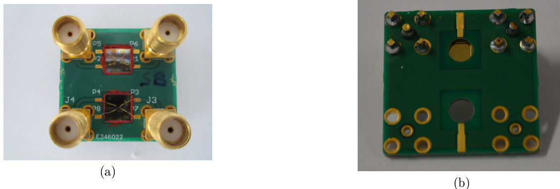
FIGURE 4.22 – Photo représentant l'étape de conditionnement des résonateurs avec les connexions électriques par soudure thermo-mécanique (a) et l'accès à la face arrière des résonateurs (b).
