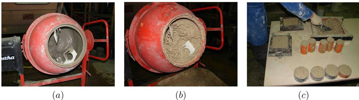
**Figure II.16** – Fabrication des échantillons de béton de chanvre, préparation du liant (a), mélange homogène de béton de chanvre (b) et fabrication des échantillons (c)
