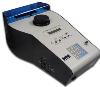
**Figure A.3** – Photographie du pycnomètre à azote
