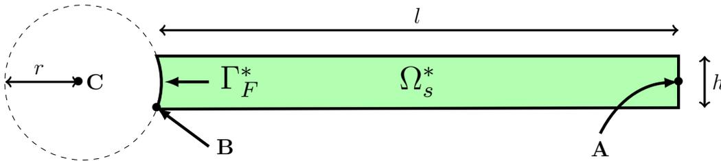
FIGURE 9.2 – Géométrie du benchmark CSM.
