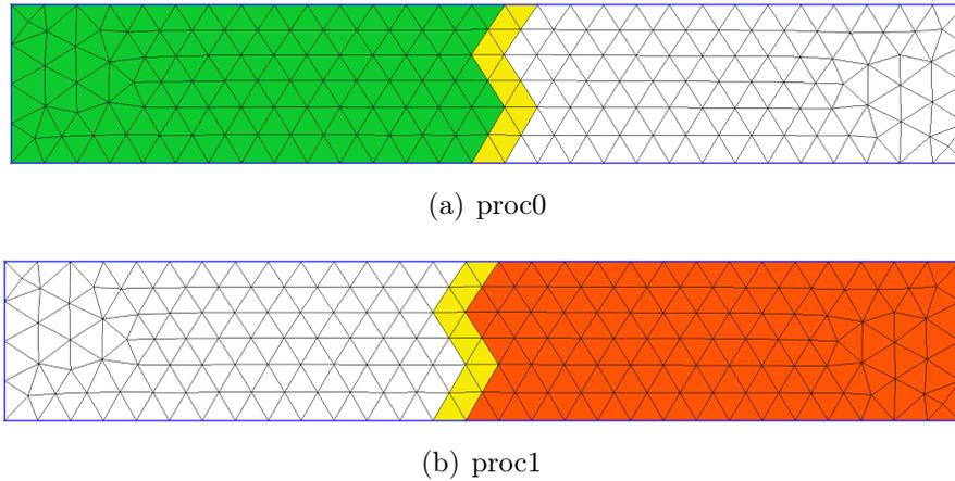
FIGURE 7.4 – Partition d'un maillage avec les cellules fantômes.
