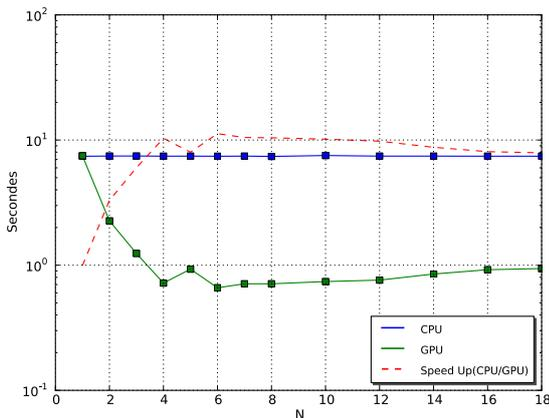
FIGURE 7.22 – Temps d'assemblage en 3D (masse+raideur) en fonction de  $\text{dimBloc}$  avec  $N = 6$ ,  $N_{elt} = 200$ .
