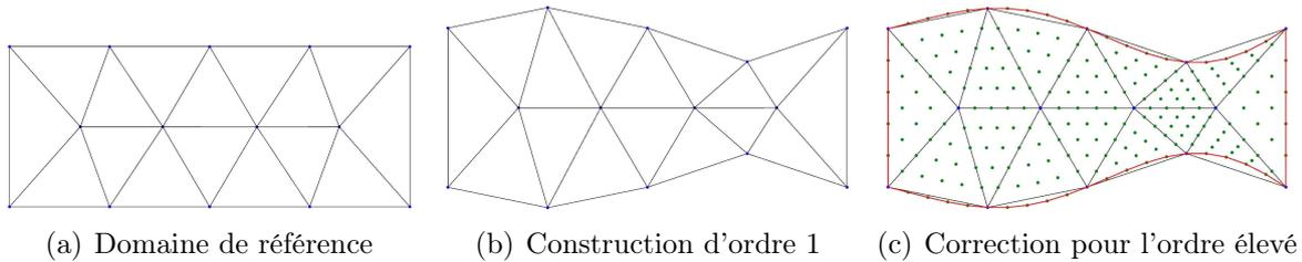
FIGURE 2.12 – Etapes de construction d'une carte  $\mathcal{A}_{(h,5)}$ .
