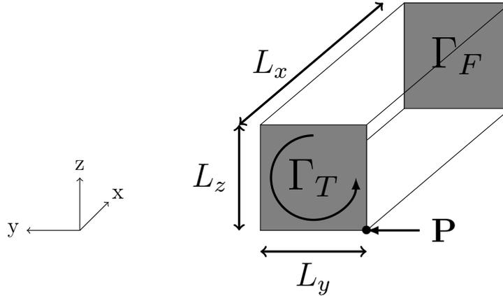
FIGURE 5.5 – Géométrie du problème de torsion de barre.
