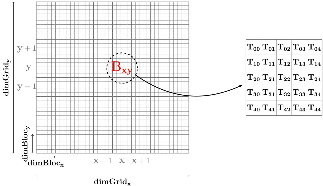
FIGURE 7.21 – Topologie bi-dimensionnelle des processus
