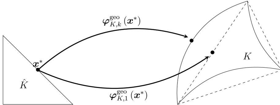
FIGURE 2.3 – Technique de raidification des éléments d'ordre élevé.
