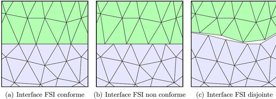
FIGURE 6.2 – Types de conformité et non-conformité de l'interface fluide structure. En bleu le domaine fluide, en vert le domaine structure.
