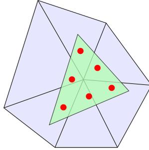
FIGURE 1.8 – Points d'intégration et intersection des maillages pour une forme linéaire. En bleu quelques éléments de  $\mathcal{T}_\delta^\omega$ , en vert un élément  $K \in \mathcal{T}_\delta^\Omega$  et en rouge les points d'intégration sur  $K$ .
