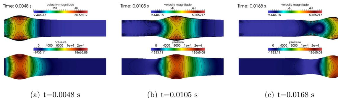
FIGURE 10.5 – Résultats obtenus à trois instants différents avec la condition de sortie utilisant le modèle de Windkessel. Pour chaque figure, nous avons affiché la magnitude de la vitesse et la pression avec une déformation amplifiée par 5.
