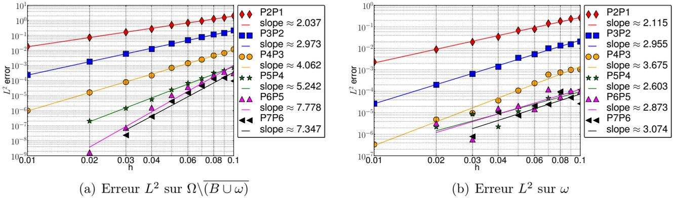
FIGURE 3.23 – Graphes de convergence mesurant l'erreur  $L^2$  et  $H^1$  de la pression en fonction du pas de maillage  $h$ . Plusieurs approximations polynomiales ont été utilisées dans ce test. Leurs pentes de convergence sont données dans les légendes associées.
