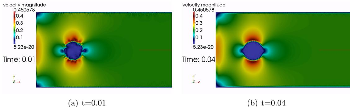
FIGURE 3.28 – Champ de vitesse obtenue avec les équations d’Oseen pour la FBM stabilisée.
