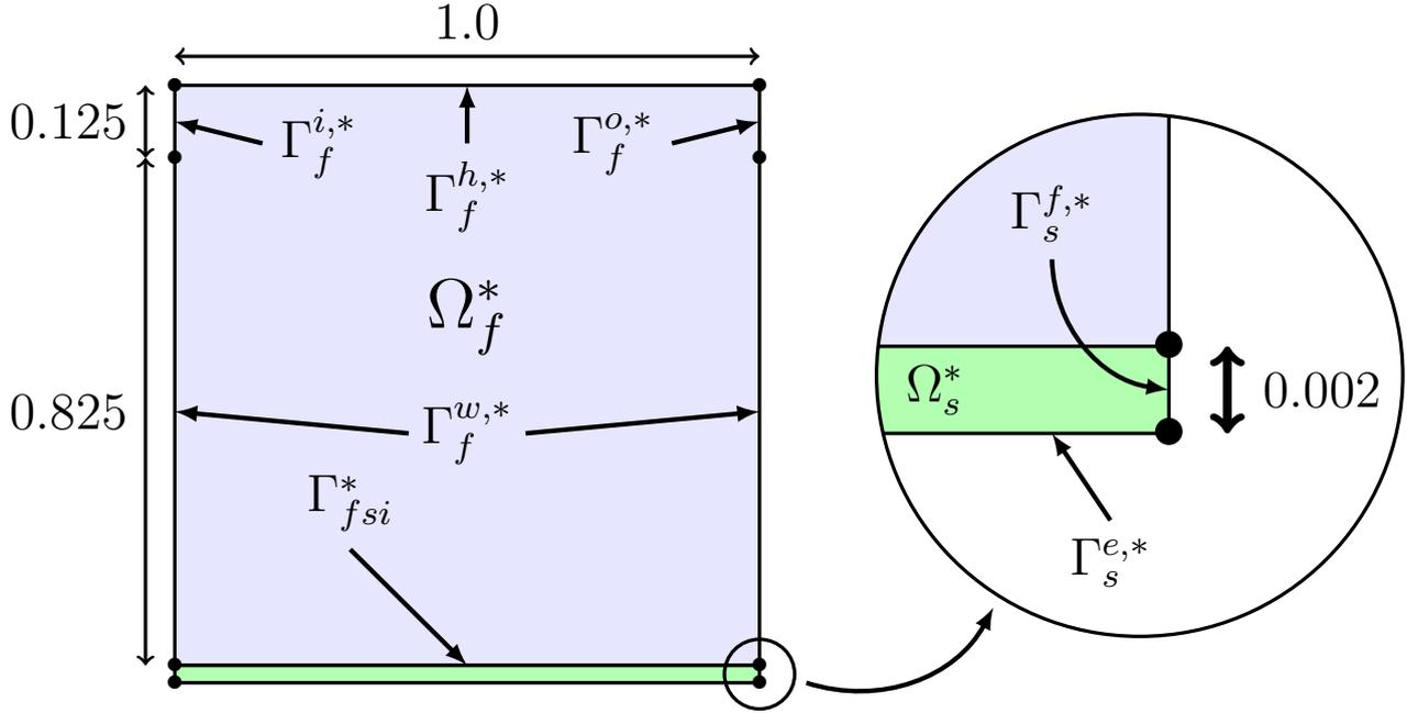
FIGURE 6.3 – Géométrie du problème FSI pour la simulation d'un écoulement dans une cavité contenant une paroi élastique.
