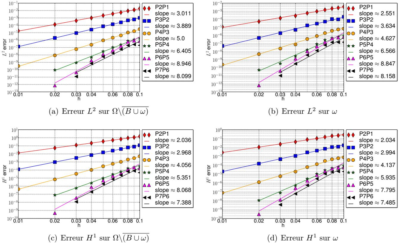
FIGURE 3.22 – Graphes de convergence mesurant l'erreur  $L^2$  et  $H^1$  de la vitesse en fonction du pas de maillage  $h$ . Plusieurs approximations polynomiales ont été utilisées dans ce test. Leurs pentes de convergence sont données dans les légendes associées.
