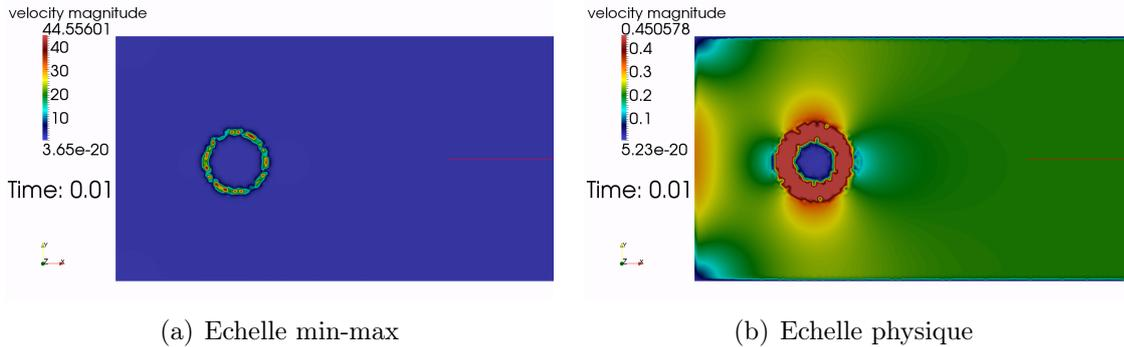
FIGURE 3.27 – Champ de vitesse obtenue avec des équations d'Oseen pour la FBM non stabilisée à  $t=0.01$ . Deux échelles de visualisation sont présentées.
