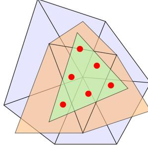
FIGURE 1.9 – Points d'intégrations et intersection des maillages pour une forme bilinéaire. En bleu quelques éléments de  $\mathcal{T}_\delta^\Omega$ , en rose quelques éléments de  $\mathcal{T}_\delta^\Gamma$ , en vert un élément  $K$  de  $\mathcal{T}_\delta^\Gamma$  et en rouge les points d'intégration sur  $K$ .
