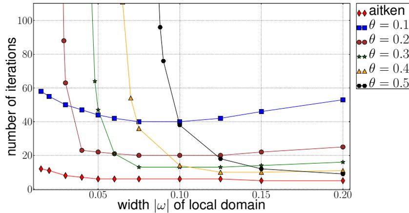
FIGURE 3.3 – Comparaison du nombre d’itérations du point fixe en fonction de la largeur  $|\omega|$  du domaine local. Nous avons utilisé plusieurs paramètres de relaxation fixes et la relaxation dynamique d’Aitken.
