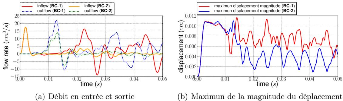
FIGURE 10.11 – Comparaison entre les conditions aux limites **BC-1** et **BC-2** en utilisant la configuration (1) avec Navier-Stokes pour le fluide et Saint-Venant-Kirchhoff compressible pour la structure.
