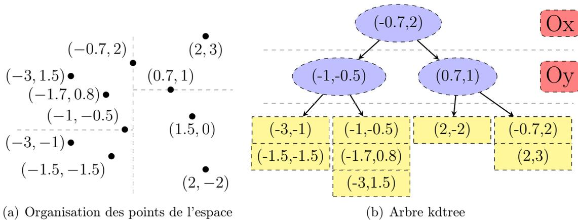
FIGURE 1.13 – Principe de la méthode kd-tree
