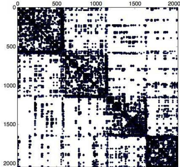
FIGURE 7.10 – Entrées non nulles de la matrice associé au problème de Stokes avec 4 processeurs (vitesse sur 4 proc, pression sur 4 proc).
