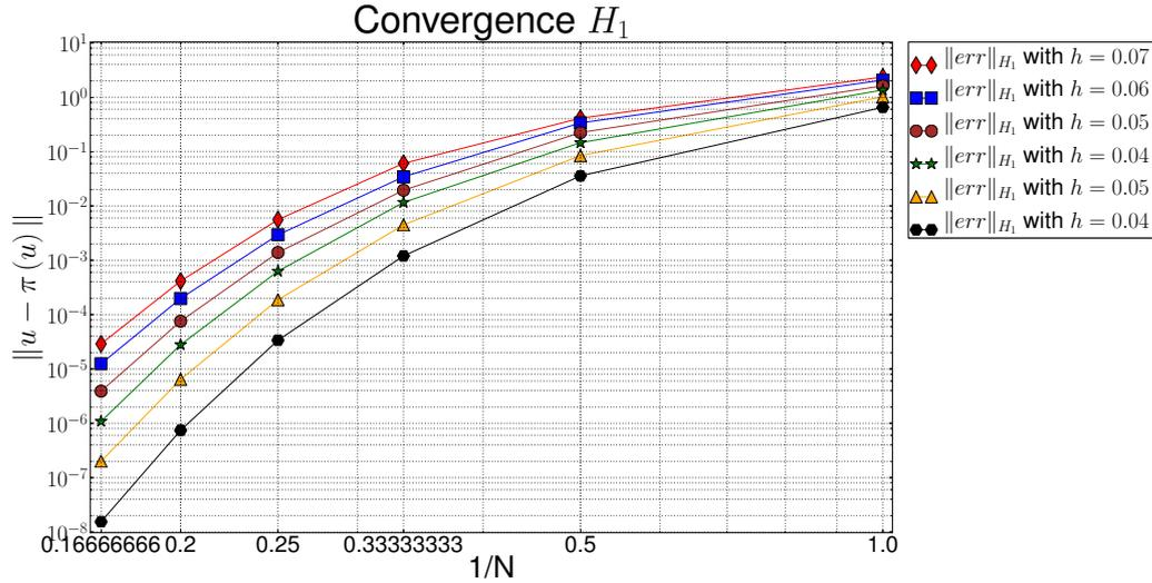
FIGURE 1.16 – Tests de convergence en  $N$  pour l'opérateur d'interpolation (échelle log-log).
