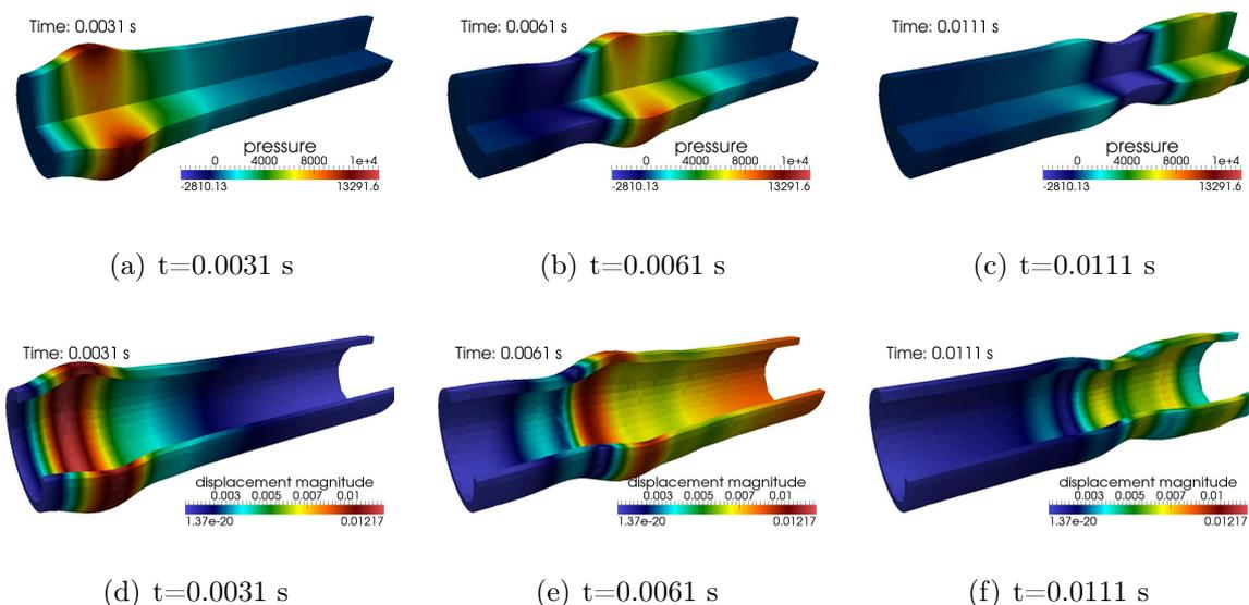
FIGURE 10.13 – Résultats obtenus à trois instants différents avec la configuration (2) et les conditions aux limites **BC-2**. Nous avons en haut la pression du fluide et en bas la magnitude du déplacement de la structure. Pour toutes les figures, la déformation du domaine est amplifiée par 15.
