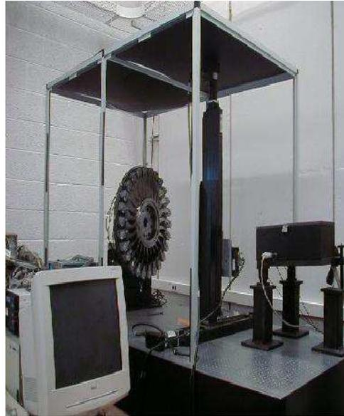
(d) Set up single point laser vibrometer and interferometry
