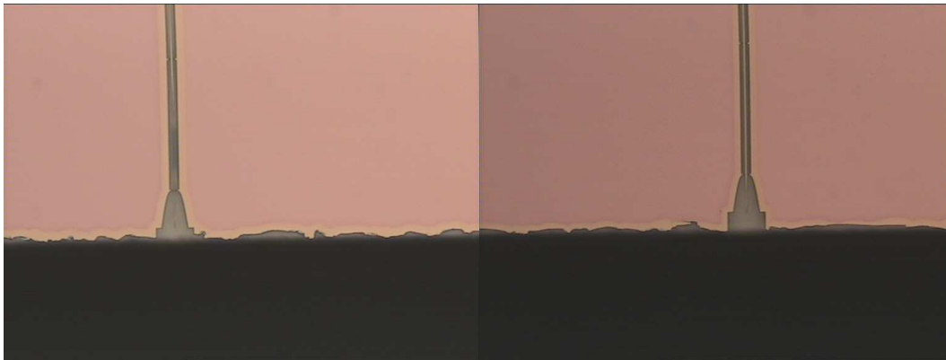
FIGURE 1.14 – Images de l’entrée des guides d’accès après la découpe et la gravure à l’acide fluorhydrique. A gauche : un guide tombé au niveau des poutrelles d’entrées. A droite : un guide intact. On peut voir les éclats de taille inférieure à 3 microns apparus lors de la découpe de l’échantillon à la scie à diamant. On peut aussi voir par transparence les endroits où la silice a été retirée en dessous de la couche de silicium (zones plus claires autour des guides).
