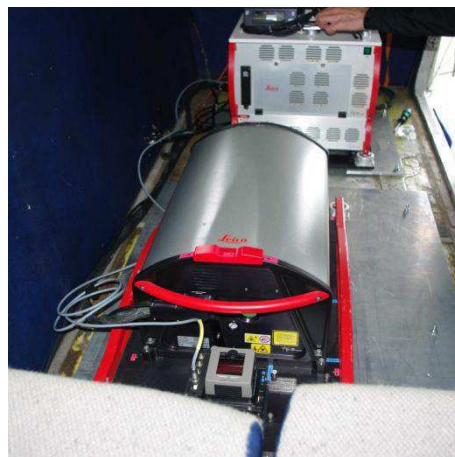
Figure I.19 : Mise en place de l'ALS60 dans l'avion
