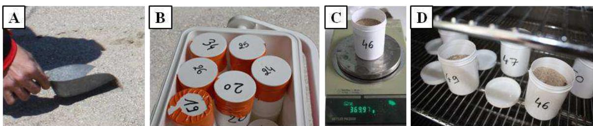
Figure IV.6 : Etapes de la mesure du taux d'humidité massique par prélèvement.
