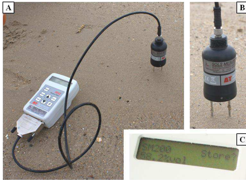
Figure IV.5 : Mesure de la teneur en eau du sol avec la sonde ThetaProbe SM200
