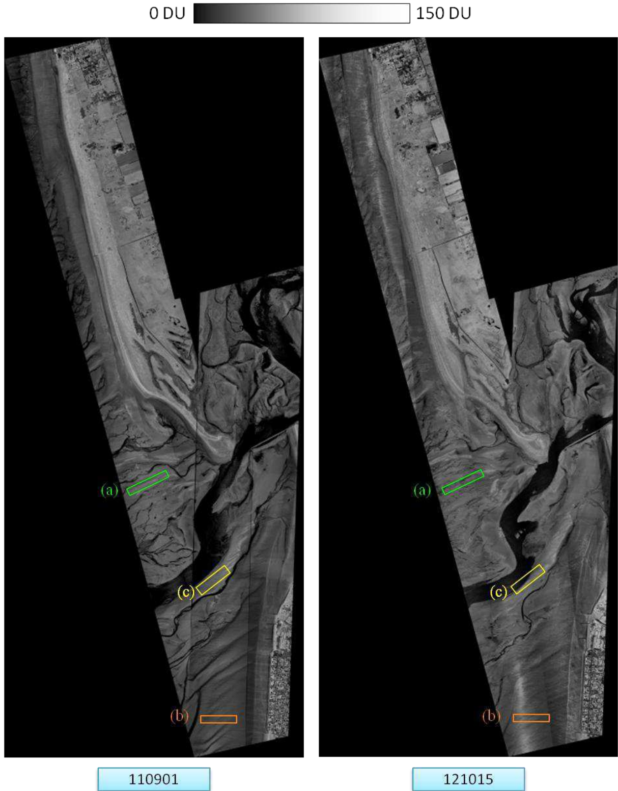
Figure V.9 : Positionnement de trois sites d'études: (a) surface sableuse dont le taux d'humidité à évolué entre les deux vols, (b) zone sableuse avec une humidité constante, (c) apparition d'une zone en eau dans la zone sableuse
