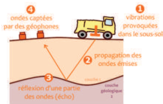
FIGURE 1.2 – Campagne sismique schématisé d'un réservoir d'hydrocarbures.
