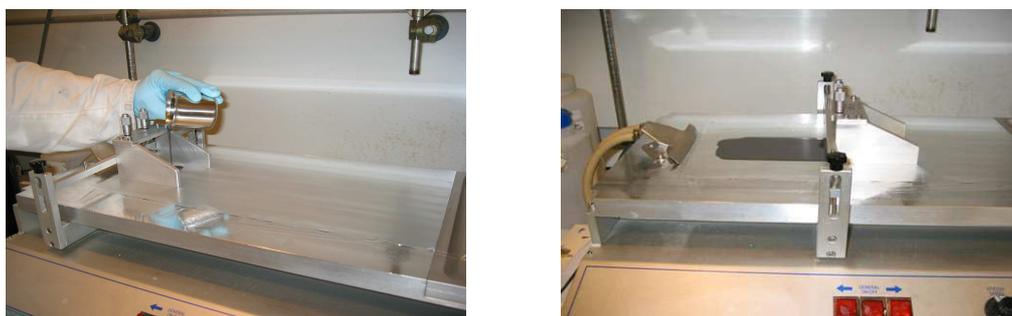
*Figure II-16 : Photos d'enduction d'une formulation d'électrode sur une table d'enduction*
