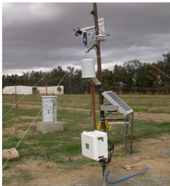
Figure II.10 : Station climatique installé sur une parcelle de sol nu.
