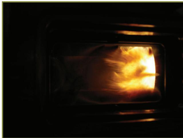
Figure 2.7 – Chambre de combustion tubulaire en fonctionnement
