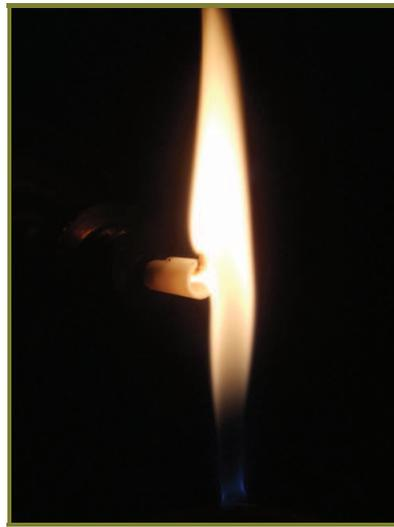
Figure 2.9 – Prélèvement avec le FPS-4000 dans une flamme de kérosène
