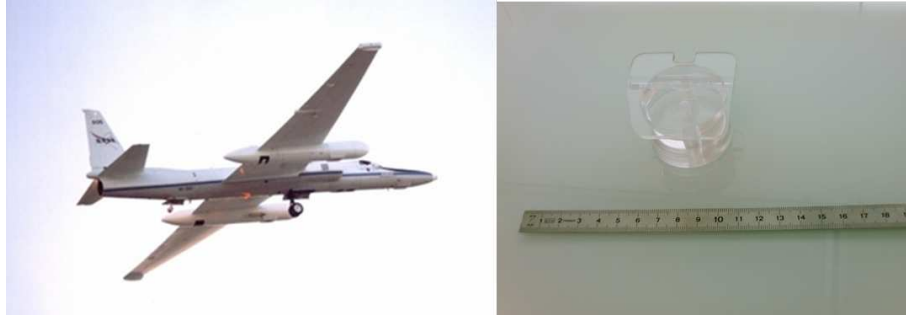
FIGURE 2.4 – Avion ER-2 de la NASA (à gauche) permettant la récolte des IDPs sur des collecteurs recouverts d'une couche de graisse de silicone (à droite).
