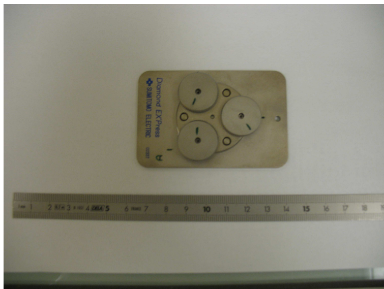
(a) Photographie de la cellule à compression vue du dessus
