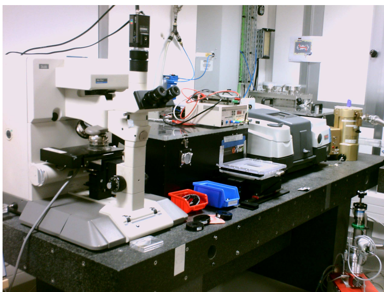
FIGURE 3.3 – Photographie du dispositif IR sur la ligne SMIS2 du synchrotron SOLEIL.
