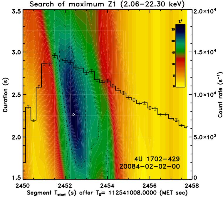
FIGURE 2.4 – Recherche du segment qui maximise la détection des oscillations du sursaut de 4U 1702–429 par le test statistique  $Z_1^2$ . En se déplaçant dans l’espace des paramètres (temps de début du segment, durée), le test permet d’obtenir une valeur de signification statistique. Le tracé des iso-contours des valeurs de  $Z_1^2$  montre qu’il existe une configuration optimale au centre de l’ellipse. Le principe est identique avec les autres tests statistiques.
