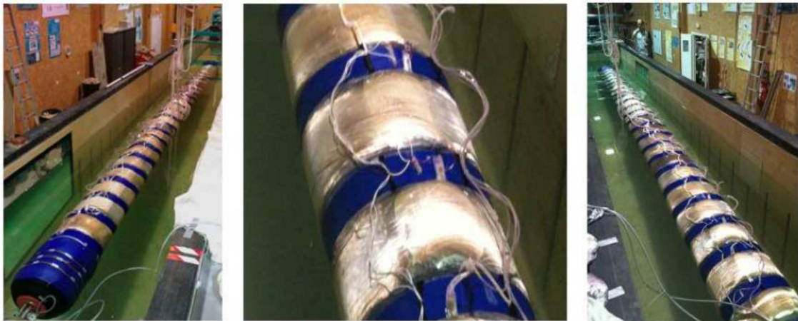
FIG. 1.3.6: Générateur à base d'élastomère diélectrique installé sur l'océan, développé par SBM Offshore [Jean 12].
