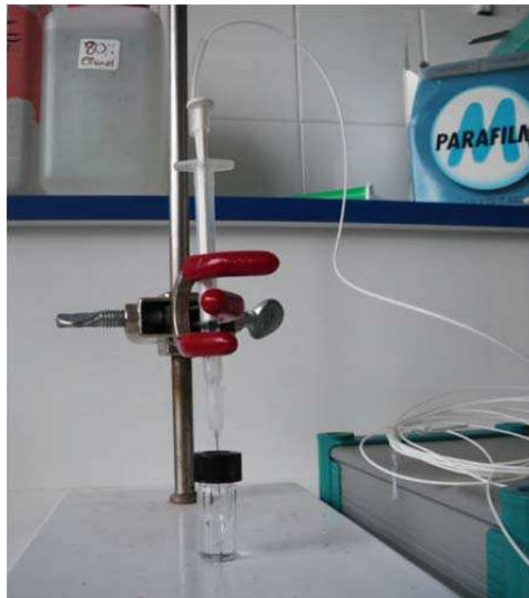
Figure II3-6: Mesure de respiration larvaire. Seringue contenant une fibre optique de résolution 50 \mu\text{m} (Presens, Regensburg, Germany) transperçant l'opercule en plastique/téflon d'une fiole de 1 mL à fond conique contenant les larves.
