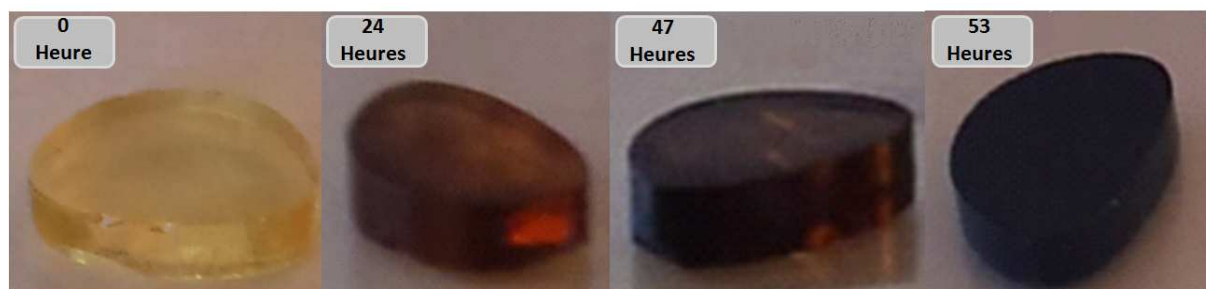
Figure 2 : Images d'une pièce issue de la préforme de 3 mm d'épaisseur, avant (0 heure) et après chauffage à 470 °C pour des durées de 24, 47 et 53 heures.
