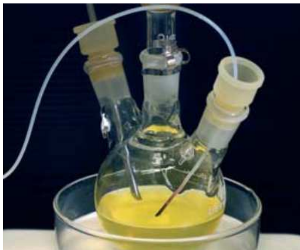
Figure 16 : Fabrication de QDs en solution par voie colloïdale
