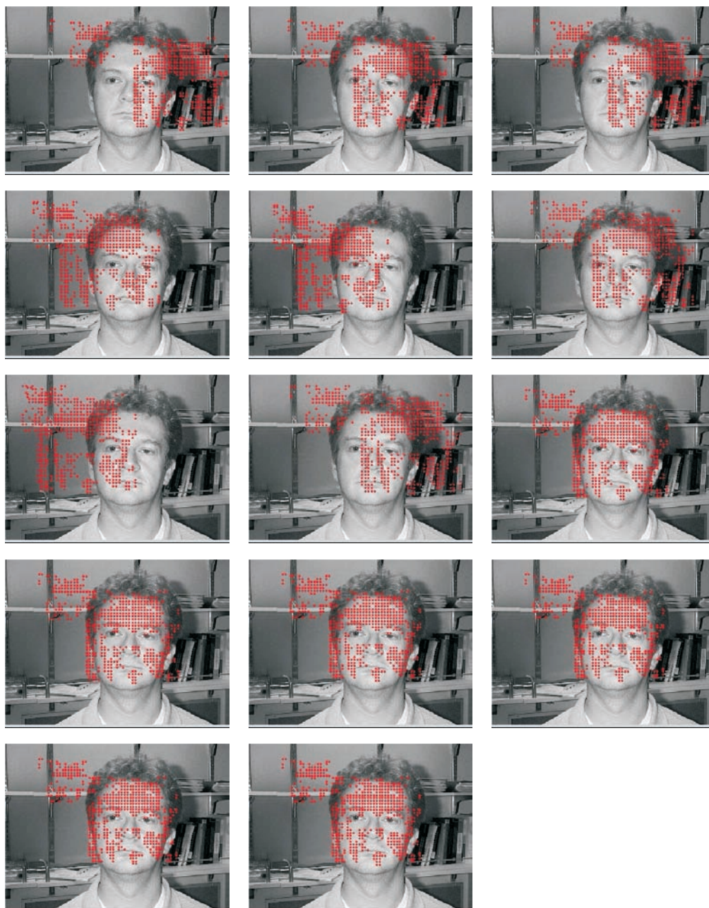
FIG. 3.19 – Différentes hypothèses testées. Pour chaque niveau de résolution, les points rouges correspondent à la position attendue des parties du visage. Lors de la recherche du visage, les « fixations » sautent d'une région à l'autre afin de tester plusieurs candidats et trouver la meilleure configuration possible en accord avec le modèle. La dernière image correspond à la détection correcte du visage.
