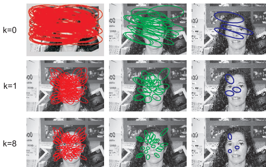
FIG. 3.14 – Sélection de la résolution. Chaque ligne représente les différents états du modèle lors de la reconnaissance. Les première, deuxième et troisième colonnes correspondent aux trois niveaux de résolution respectivement (de plus élevé au plus bas).
