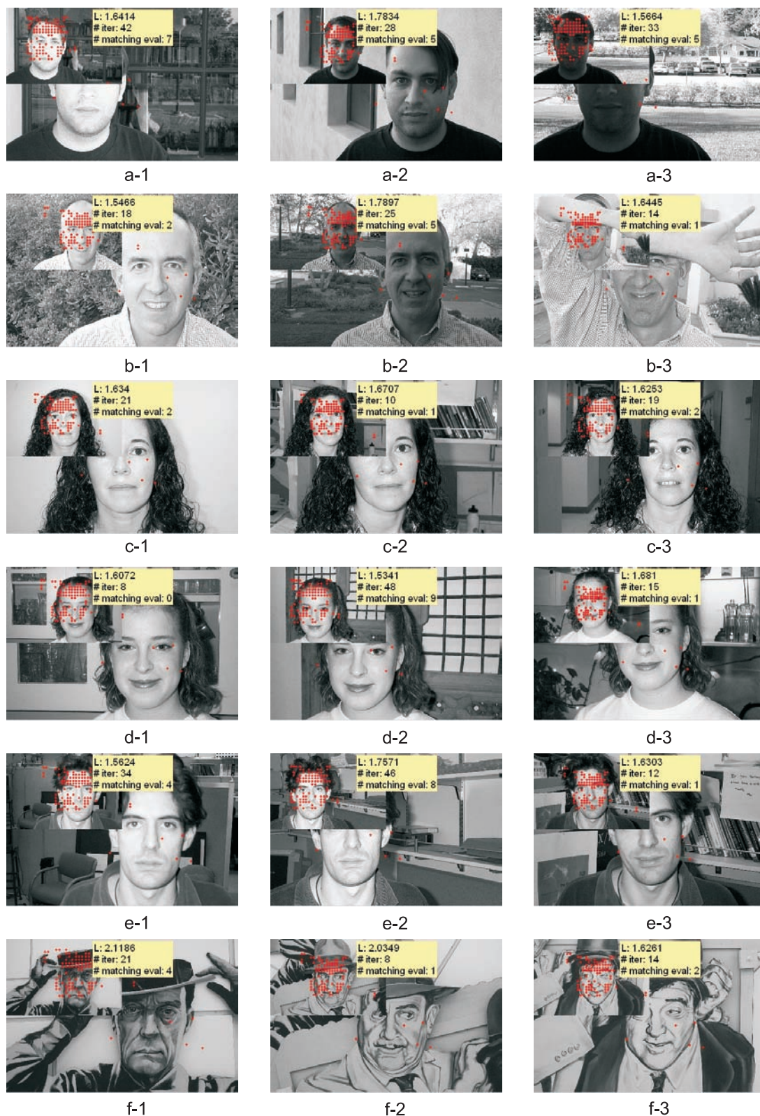
FIG. 3.22 – Exemples de reconnaissance de visages avec le modèle réduit. Uniquement les 50 parties les plus corrélées sont gardées. Avec ce modèle le temps de détection est d'environ 1s par image.
