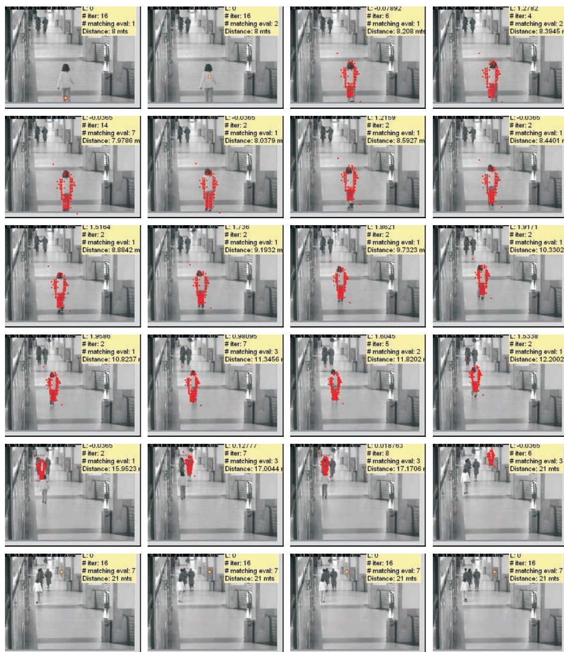
FIG. 3.32 – Exemple du piéton s'éloignant de la caméra. Ici, les paramètres de la caméra (angle et hauteur) sont initialisés pour que le système soit « attentif » aux piétons qui puissent apparaître tout au début du couloir. Le fait d'intégrer de l'information 3D sur la scène, aide à réduire significativement les fausses détections. Les objets qui sont détectés sont ceux qui ont une cohérence en accord avec la structure de la scène : des piétons apparaissant de grande taille en bas, et de petite taille vers l'horizon. La prise en compte de cette information entraîne une amélioration de la détection du piéton lors du suivi de celui-ci.
