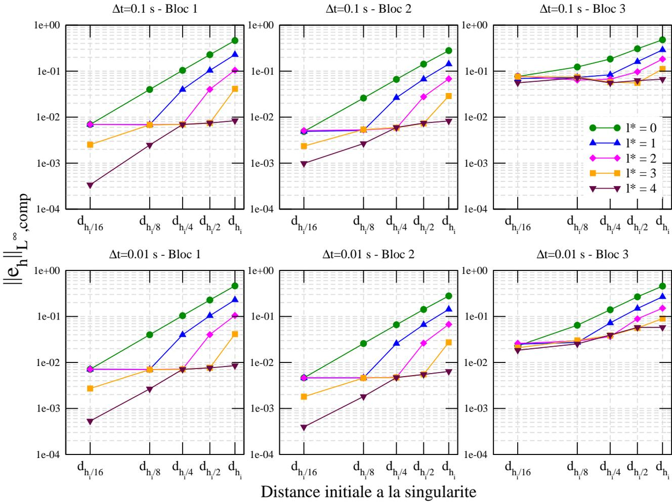
FIGURE IV.17 – Norme  $L^\infty$  relative composite de l'erreur en fonction de la distance initiale à la singularité et du bloc de chargement - Cas 2D( $r, \theta$ ) - Fluage de Norton -  $\Delta t = 0.1$  s et  $\Delta t = 1.10^{-2}$  s
