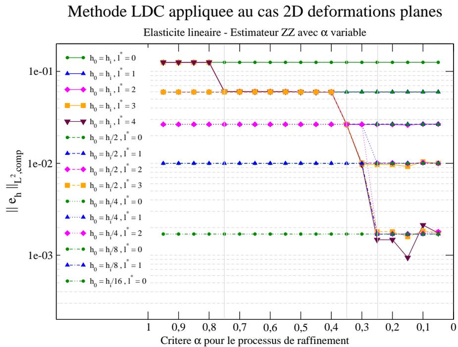
FIGURE III.7 – Norme  $L^2$  relative composite de l'erreur en fonction du critère  $\alpha$  utilisé durant le processus de raffinement - Cas 2D( $r, \theta$ ) - Élasticité linéaire
