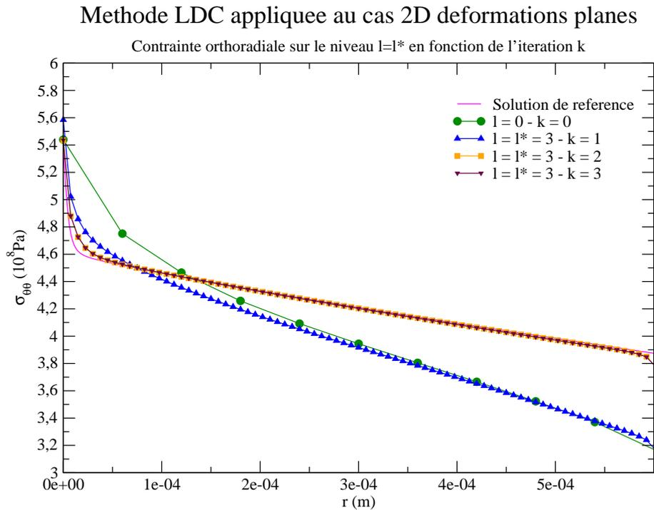
FIGURE II.16 – Contrainte orthoradiale du niveau  $l^*$  le long du plan de symétrie en fonction de l'itération de calcul - Cas 2D( $r,\theta$ ) - Élasticité linéaire - Maillage *a priori* -  $h_0 = h_i/2$  et  $l^* = 3$
