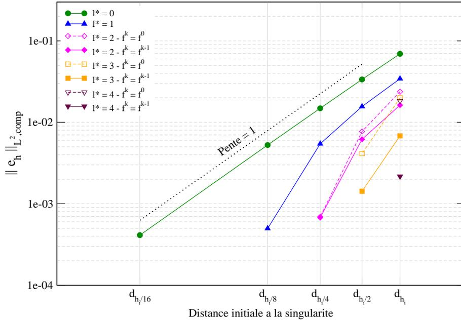
FIGURE II.9 – Norme  $L^2$  relative composite de l’erreur en fonction de la distance initiale à la singularité - Cas 2D( $r,z$ ) - Élasticité linéaire - Maillage *a priori* - Comparaison entre le second membre “initial” ( $f_{l,p}^k = f_l^0$ ) et “corrigé” ( $f_{l,p}^k = f_{l,r}^{k-1}$ )
