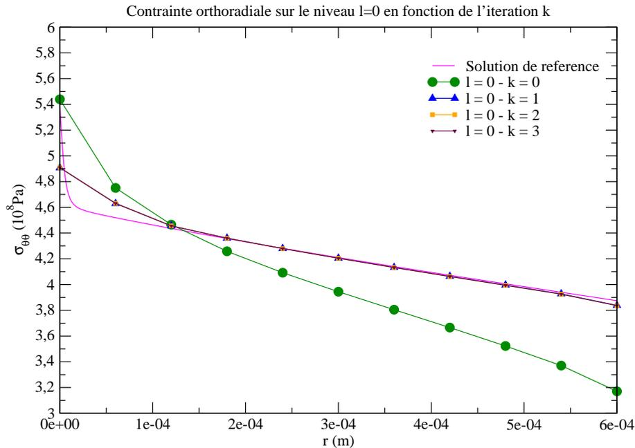
FIGURE II.15 – Contrainte orthoradiale du niveau 0 le long du plan de symétrie en fonction de l'itération de calcul - Cas 2D( $r, \theta$ ) - Élasticité linéaire - Maillage *a priori* -  $h_0 = h_i/2$  et  $l^* = 3$
