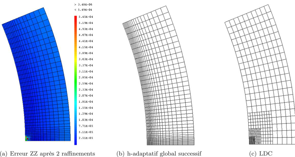
FIGURE III.25 – Comparaison des maillages composites obtenus par raffinement h-adaptatif global successif et par la méthode LDC - Cas 2D( $r, \theta$ ) - Élasticité linéaire -  $h_0 = h_i/2$  et  $l^* = 3$
