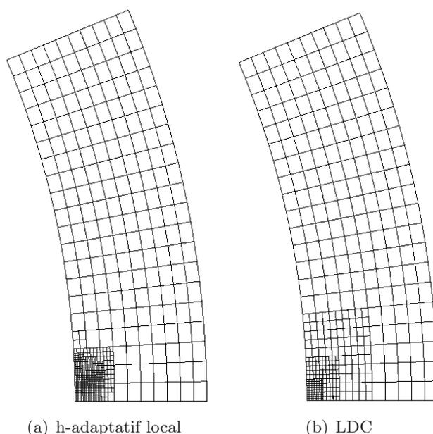
FIGURE III.30 – Comparaison des maillages composites obtenus par raffinement h-adaptatif local non conforme et par la méthode LDC - Cas  $2d(r,\theta)$  - Élasticité linéaire - Estimateur d'erreur *a posteriori* ZZ avec  $\alpha = 0.25$  -  $h_0 = h_i/2$  et  $l^* = 3$
