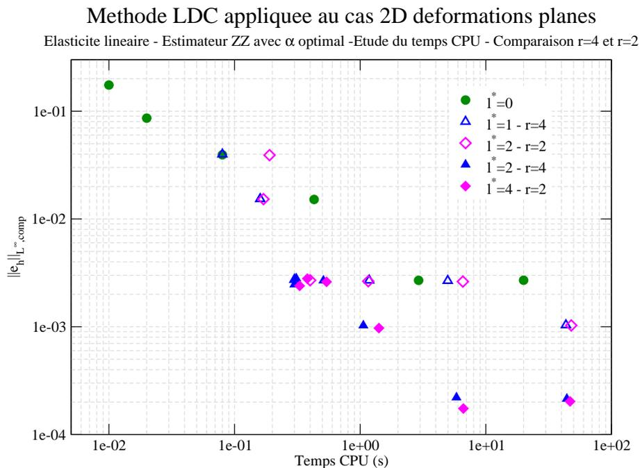
FIGURE III.12 – Norme  $L^\infty$  relative composite de l'erreur en fonction du temps CPU - Cas 2D( $r, \theta$ ) - Élasticité linéaire - Estimateur d'erreur *a posteriori* ZZ avec  $\alpha$  optimal - Comparaison des rapports de raffinement  $r = 2$  et  $r = 4$
