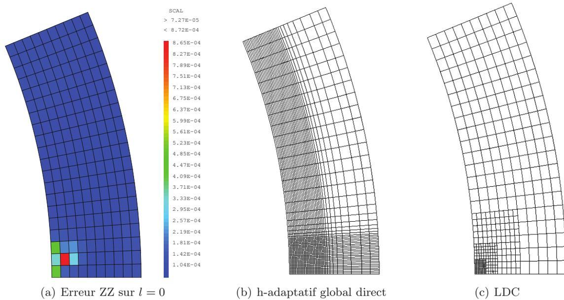
FIGURE III.24 – Comparaison des maillages composites obtenus par raffinement h-adaptatif global direct et par la méthode LDC - Cas 2D( $r, \theta$ ) - Élasticité linéaire -  $h_0 = h_i/2$  et  $l^* = 3$
