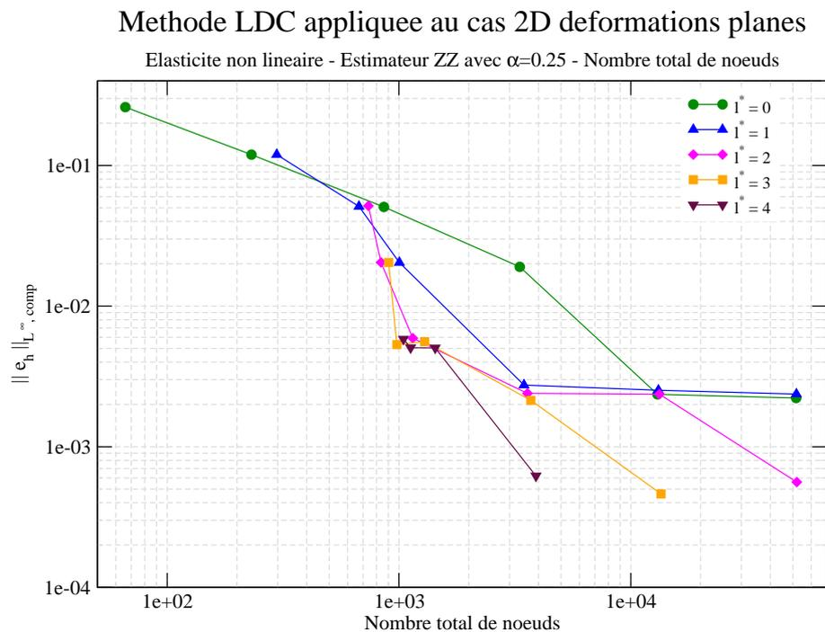
FIGURE IV.6 – Norme  $L^\infty$  relative composite de l'erreur en fonction du nombre total de noeuds - Cas 2D( $r,\theta$ ) - Élasticité non linéaire - Estimateur d'erreur *a posteriori* ZZ avec  $\alpha = 0.25$
