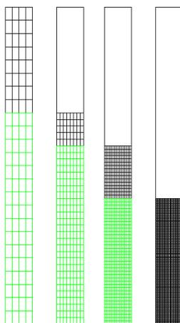
FIGURE III.5 – Exemple de maillages imbriqués - Estimateur d'erreur *a posteriori* ZZ avec  $\alpha = 0.15$  (maillage courant en noir, zone à raffiner en vert) - Cas 2D( $r,z$ ) - Élasticité linéaire -  $h_0 = h_i = 327 \mu\text{m}$  et  $l^* = 3$
