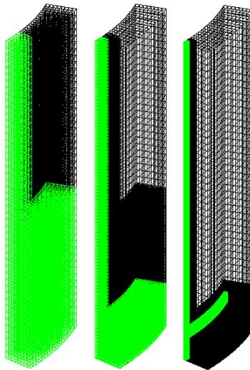
FIGURE III.14 – Exemple de maillages imbriqués - Estimateur d'erreur *a posteriori* ZZ avec  $\alpha = 0.25$  (maillage courant en noir, zone à raffiner en vert) - Cas 3D - Élasticité linéaire -  $h_0 = h_i/2$  et  $l^* = 3$
