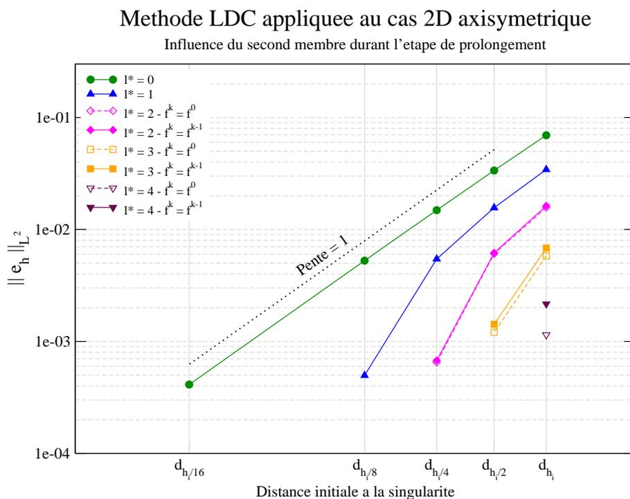
FIGURE II.8 – Norme  $L^2$  relative de l’erreur en fonction de la distance initiale à la singularité - Cas 2D( $r,z$ ) - Élasticité linéaire - Maillage *a priori* - Comparaison entre le second membre “initial” ( $f_{l,p}^k = f_l^0$ ) et “corrigé” ( $f_{l,p}^k = f_{l,r}^{k-1}$ )
