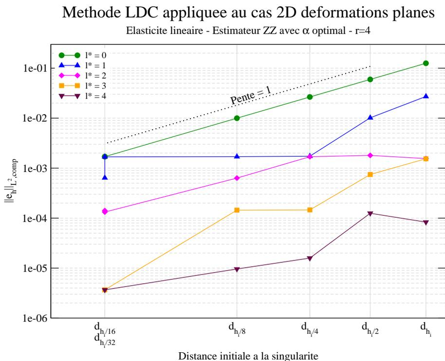
FIGURE III.11 – Norme  $L^2$  relative composite de l'erreur en fonction de la distance initiale à la singularité - Cas 2D( $r, \theta$ ) - Élasticité linéaire - Estimateur d'erreur *a posteriori* ZZ avec  $\alpha$  optimal - Rapport de raffinement  $r=4$
