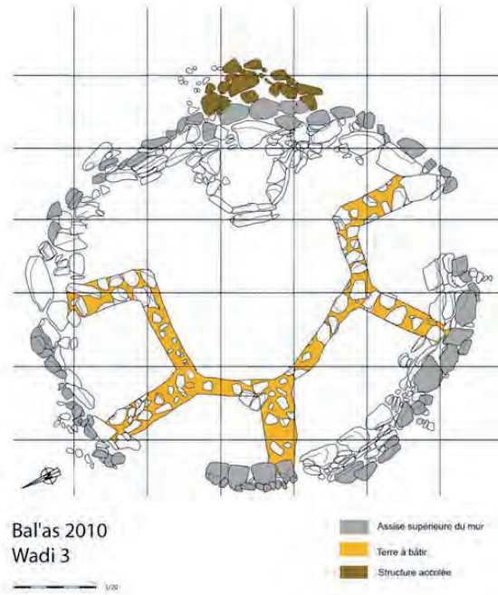
Construction EA-6 niveau 4 de Wadi Tumbaqa 3 (Abbès 2010, fig. 22, p. 19)
